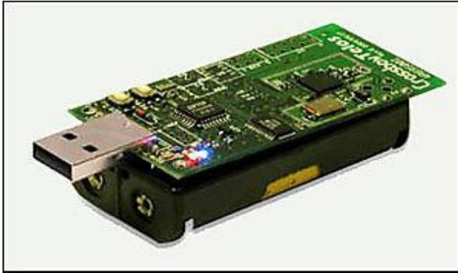
Figure 3: Exemple de capteur intelligent Telosb de Crossbow [1]
