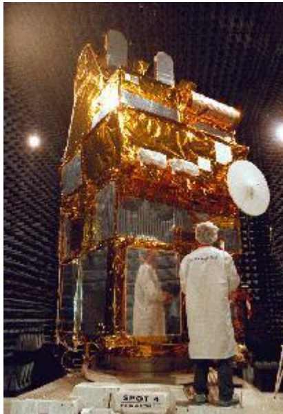
Figure I.3 : Peau super isolante du satellite
