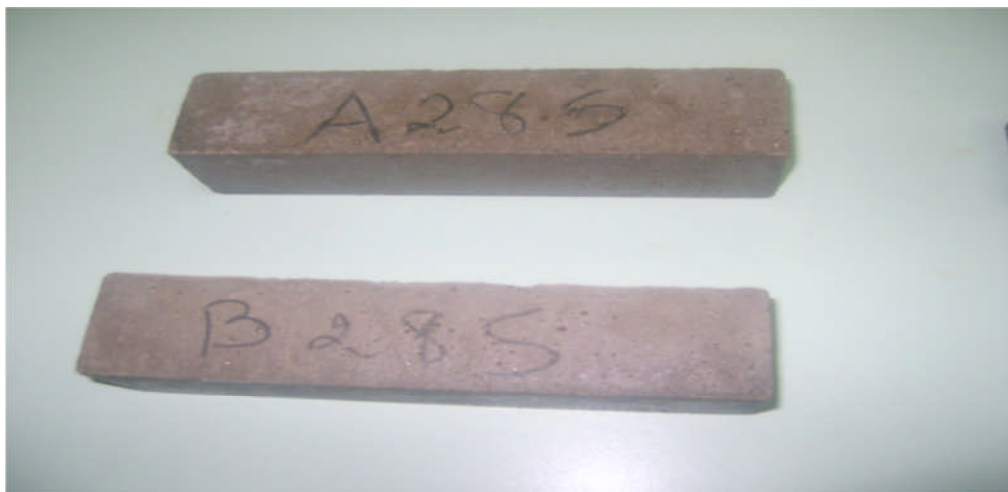
Figure 4.11 : Etat d'éprouvette après immersion de 28 jours dans l'eau de robinet.
