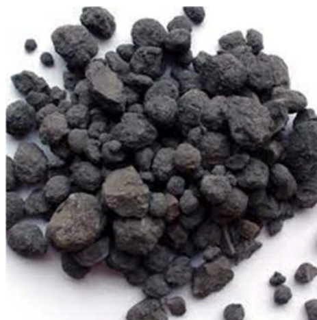
Figure 1.2 : Nodules de clinker de Béni-Saf de taille environ 20 mm.
