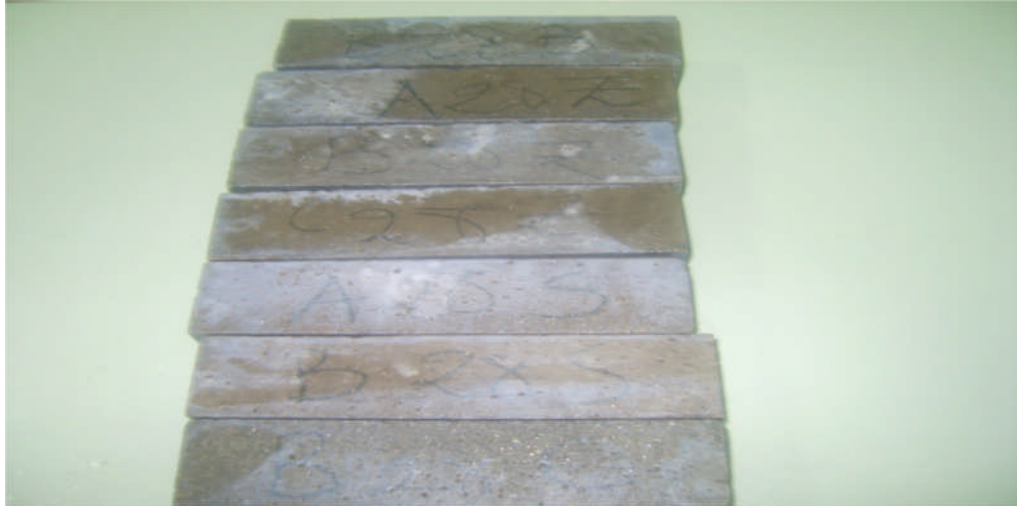
Figure 4.10 : Etat d'éprouvette après immersion de 28 jours dans l'eau de mer.
