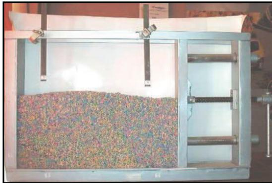
**Figure. 2** Dispositif expérimental de poussée – butée (Réf : 01-DPB-040404)
