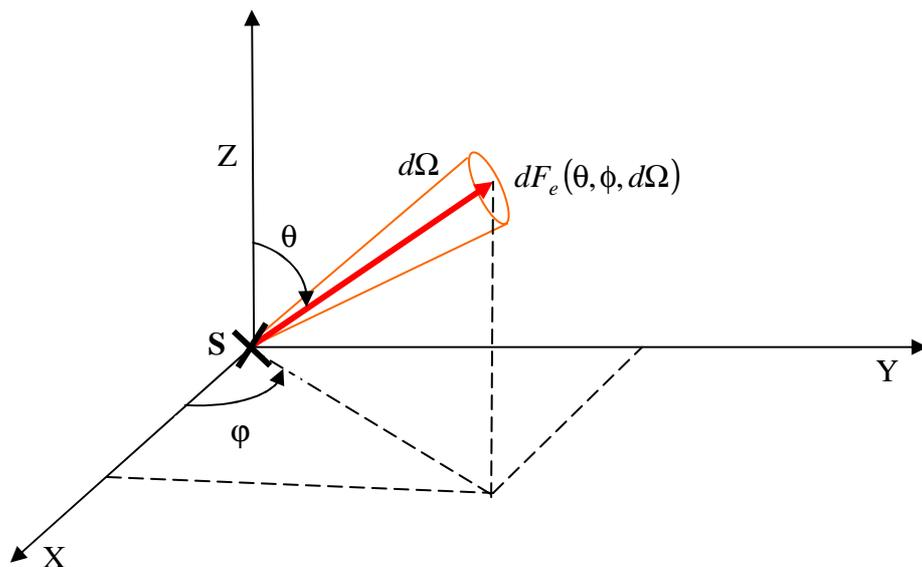
Figure III.2 - Intensité d'une source lumineuse S.
