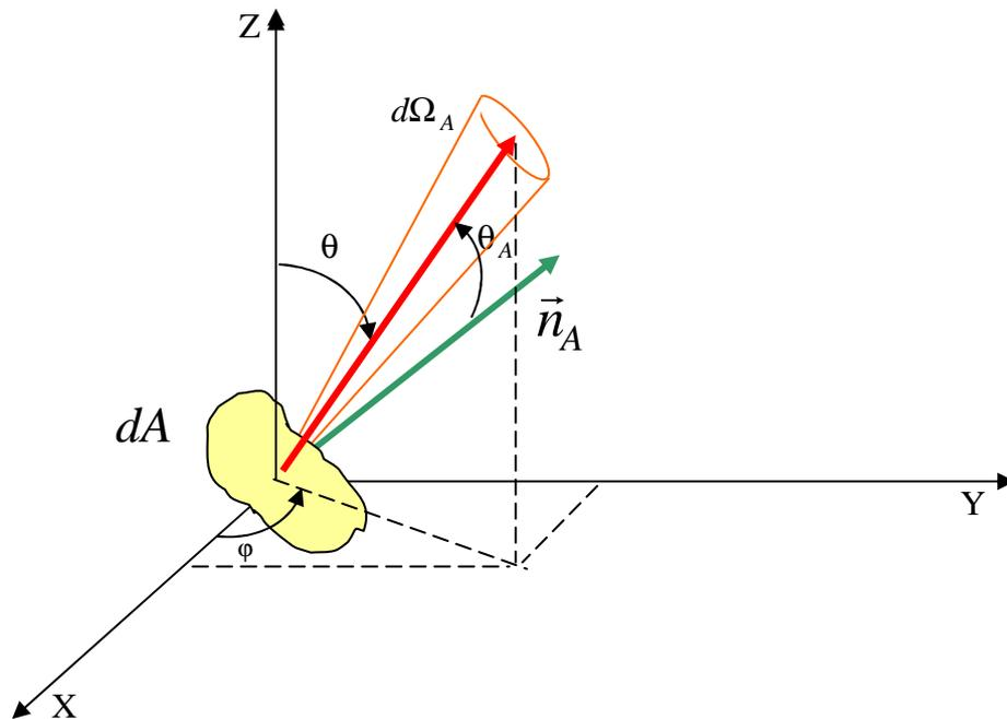
Figure III.3 - Paramètres de définition de la luminance d'une source étendue finie.
