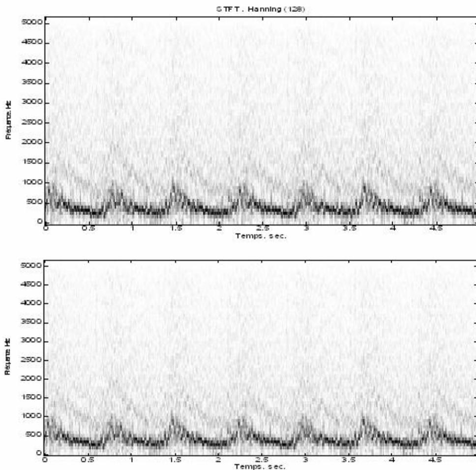
**Figure 4-4 :** spectrogramme du signal Doppler de l'artère carotide obtenu par l'utilisation de la fenêtre (a) Hanning à 128 points et (b) Hamming à 128 points.
