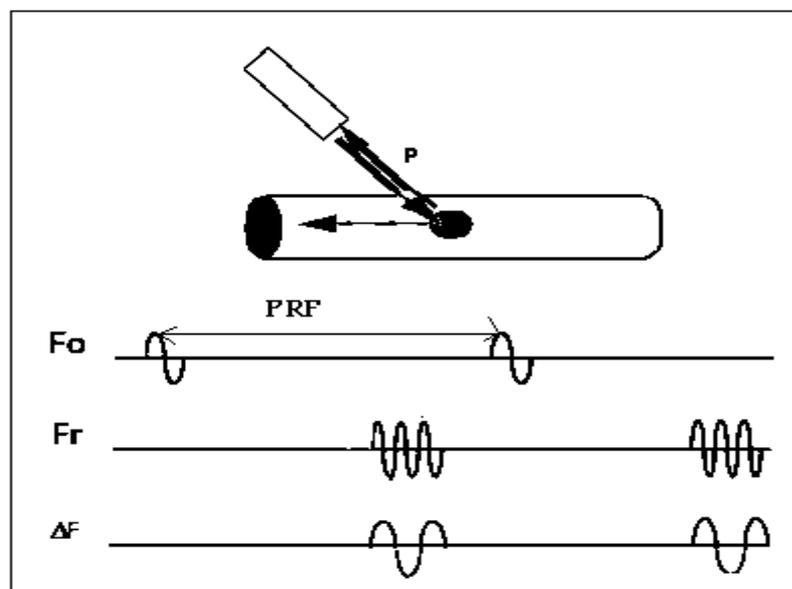
Figure 1-4 : Principe du Doppler pulsé
