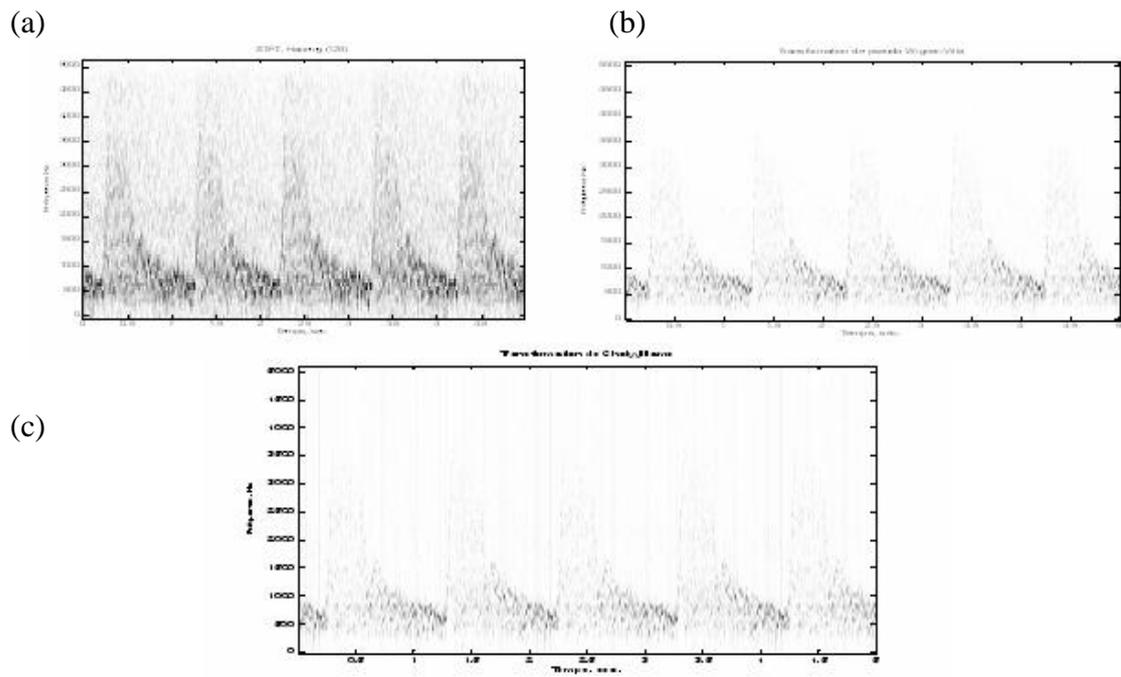
**Figure 6-8 :** Sonogramme de l'enregistrement 13 (sténose de 50%) calculé par : (a) la STFT, (b) la DPWVL, (c) la DCW
