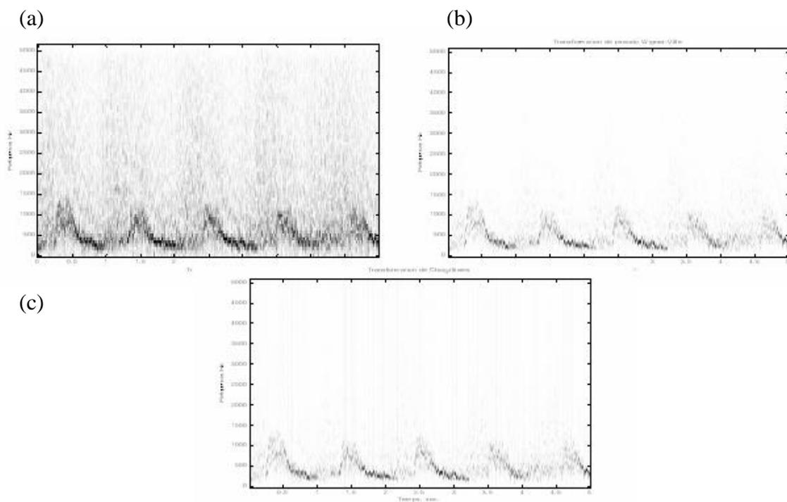
**Figure 6-11 :** Sonogramme de l'enregistrement 16 (sténose de 68%) calculé par : (a) la STFT, (b) la DPWVL, (c) la DCW
