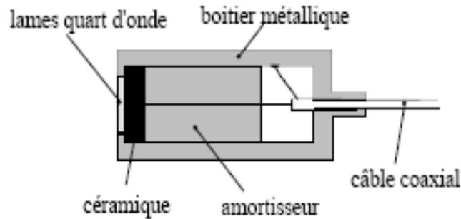
**Figure 1-7 :** Coupe typique d'un transducteur ultrasonore
