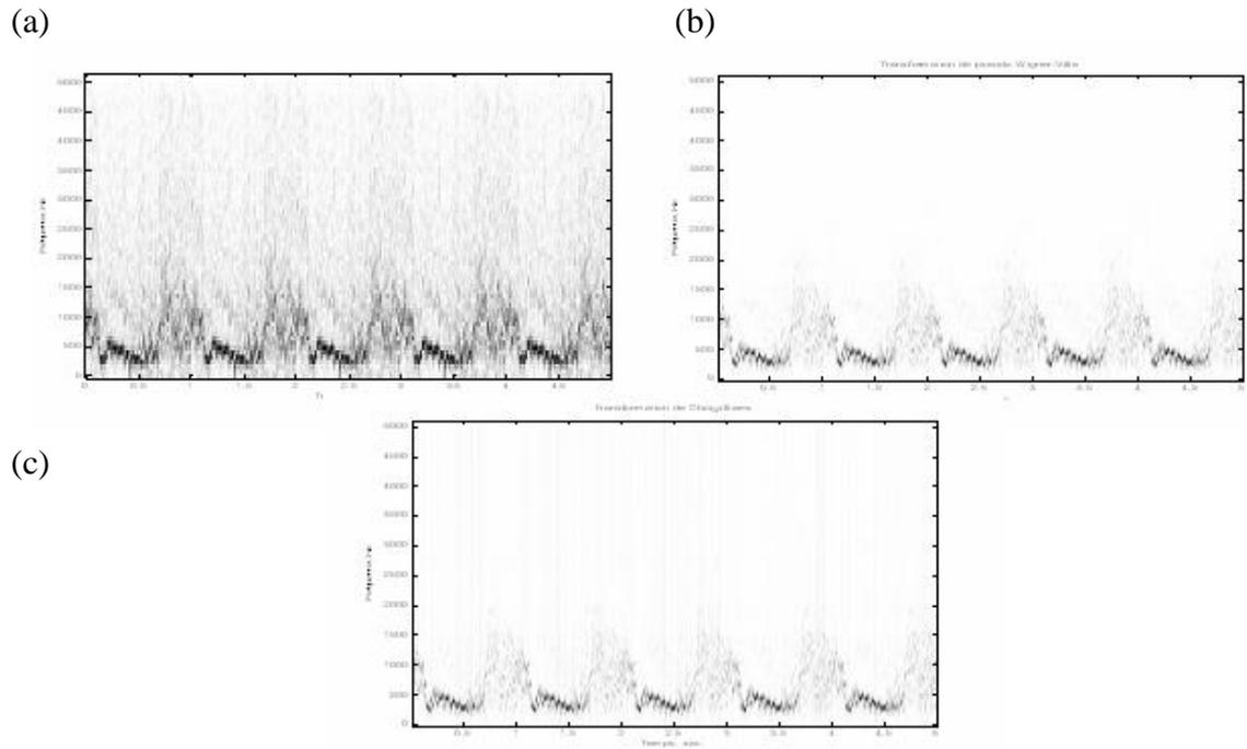
**Figure 6-4** : Sonogramme de l'enregistrement 9 (sténose de 45%) calculé par : (a) la STFT, (b) la DPWVL, (c) la DCW
