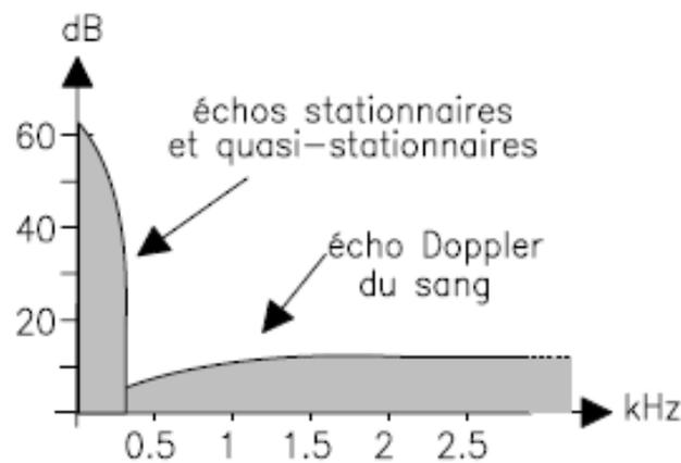
**Figure 1-2 :** Différence d'amplitude entre les échos stationnaires et ceux
