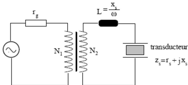
**Figure 1-8 :** Circuit adaptant l'impédance électrique de la sonde à celle du Générateur
