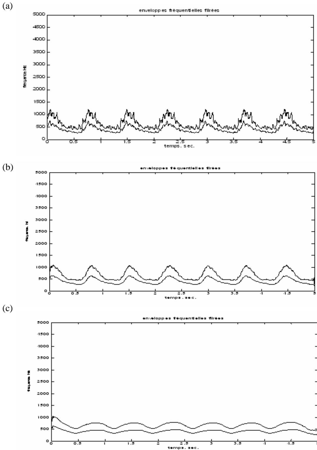
**Figure 5-6 :** Enveloppes fréquentielles maximales et moyennes obtenue par la DCW et filtrée par un filtre moyeneur de: (a) 100 points , (b) 500 points, (c)1000 points.
