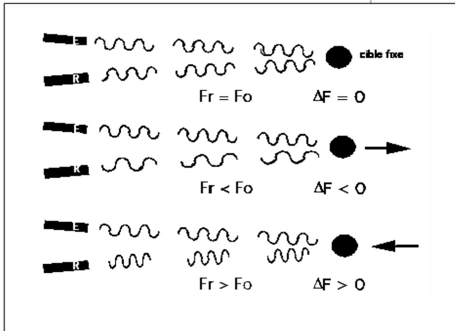
**Figure 1-1 :** Principe de l'effet Doppler
