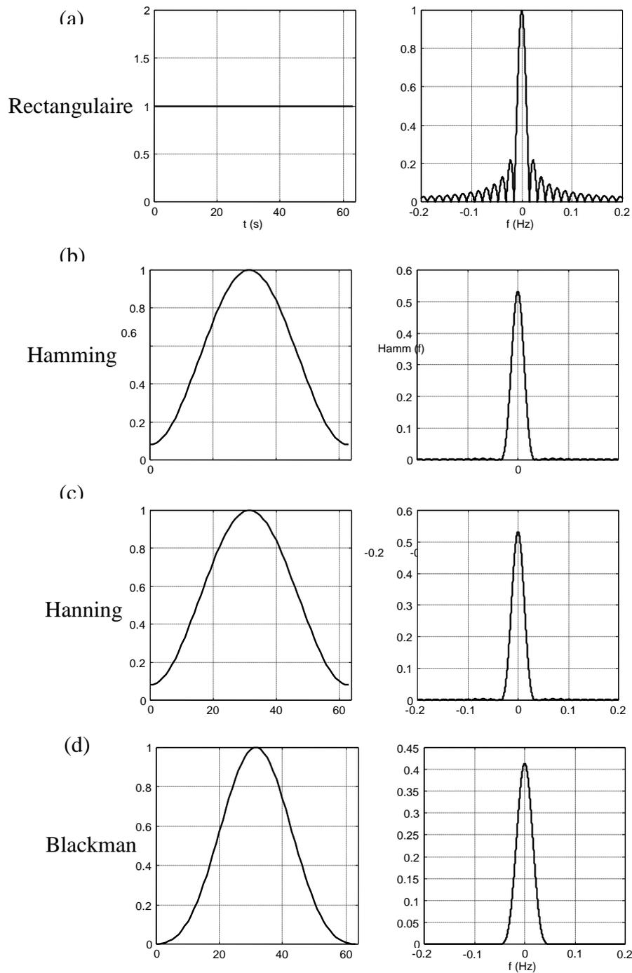
**Figure 4-3 :** Représentations temporels et spectrales des fenêtres d'analyse : (a) Rectangulaire, (b) Hamming, (c) Hanning, (d) Blackman.
