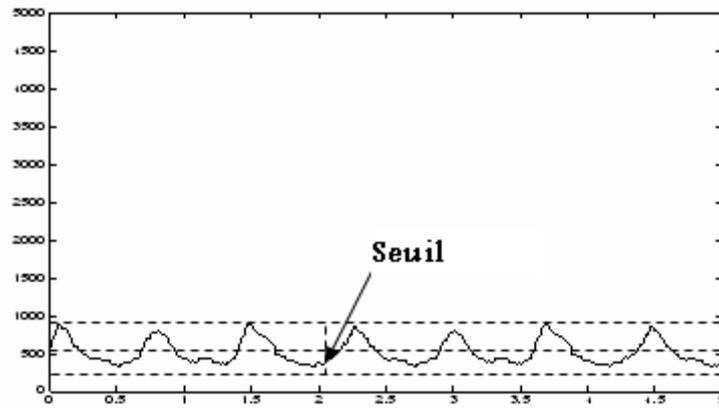
**Figure 5-7 :** Implémentation du seuil pour éliminer les pics non systoliques.
