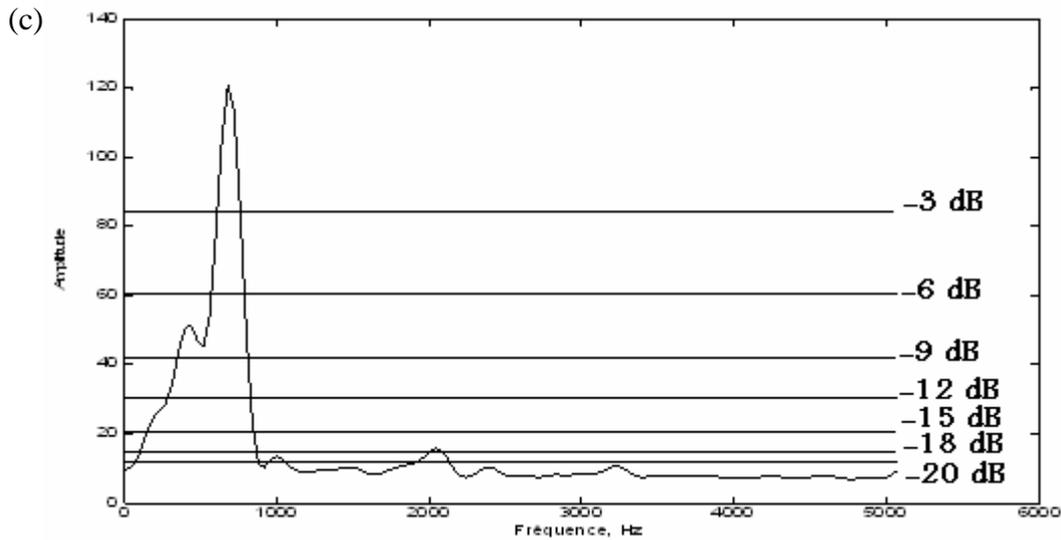
**Figure 5-2 :** Implémentation du seuil pour le calcul des fréquences maximales et minimales : (a) spectre instantané calculé par STFT, (a) spectre instantané calculé par DPWVL, (a) spectre instantané calculé par DCW.
