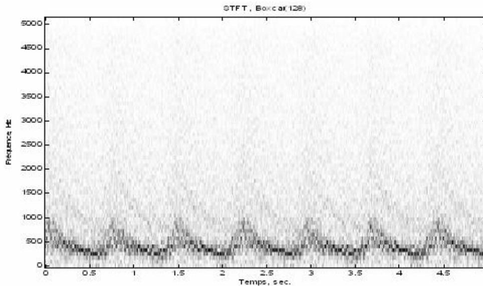
**Figure 4-2 :** Spectrogramme du signal Doppler de l'artère carotide en utilisant une fenêtre rectangulaire de 128 points
