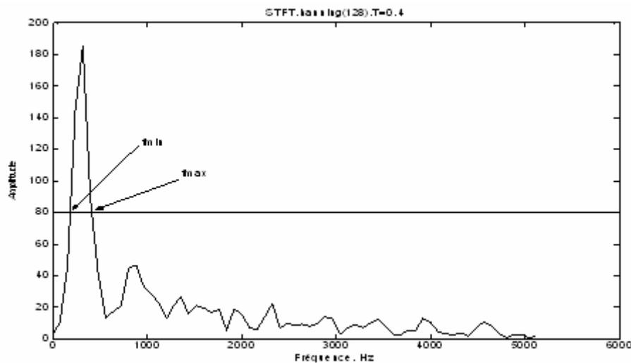
**Figure 5-1 :** Détermination des fréquences maximales et moyenne à partir du seuillage.
