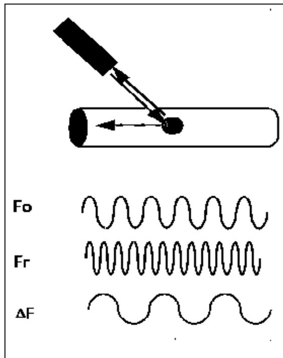
**Figure 1-3** : Principe du Doppler continue
