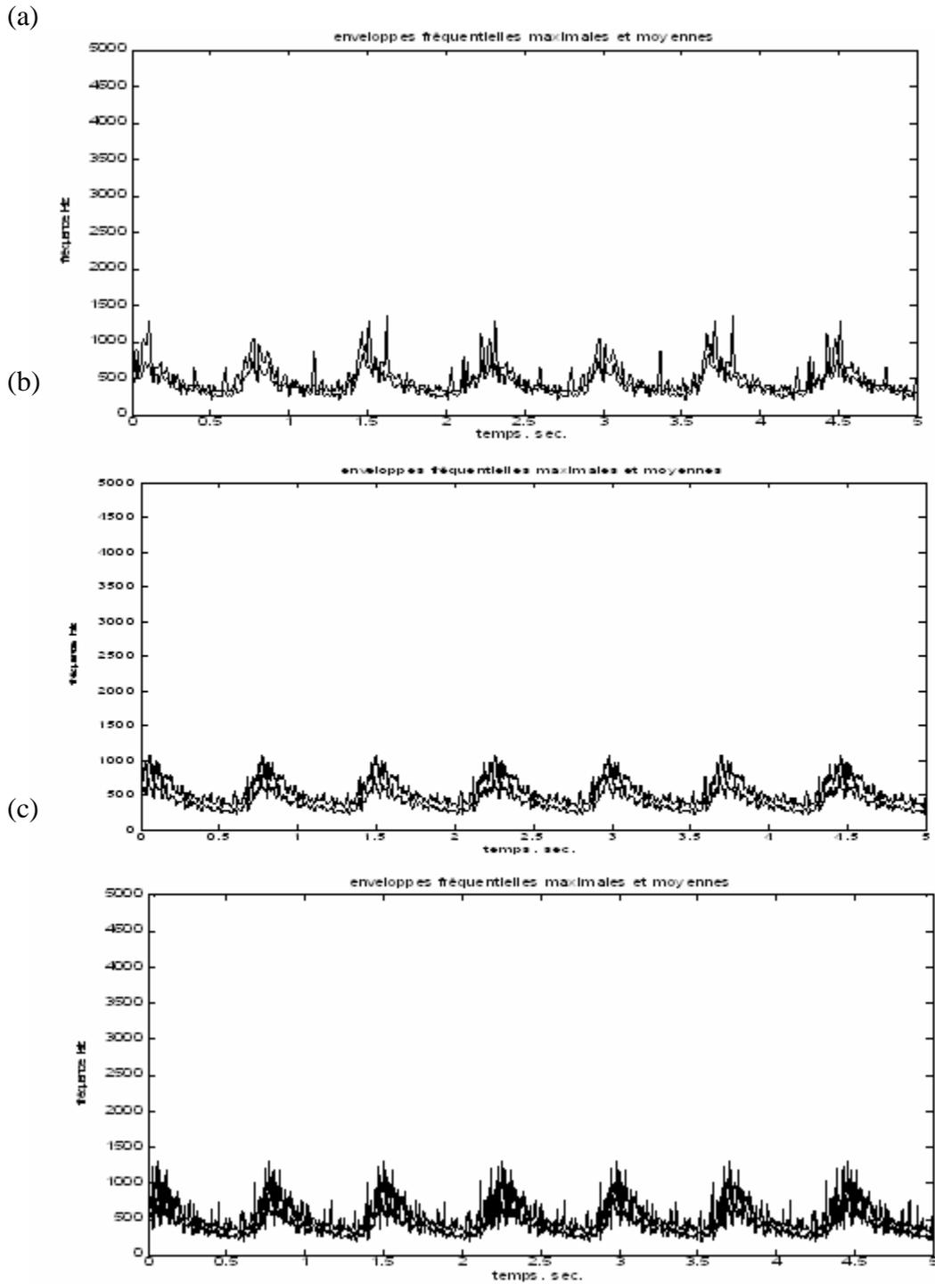
**Figure 5-3 :** Enveloppes fréquentielles maximales et moyennes extraites: (a) à partir du sonogramme calculé par la STFT, (b) à partir du sonogramme calculé par la DPWVL, (c) à partir du sonogramme calculé par la DCW
