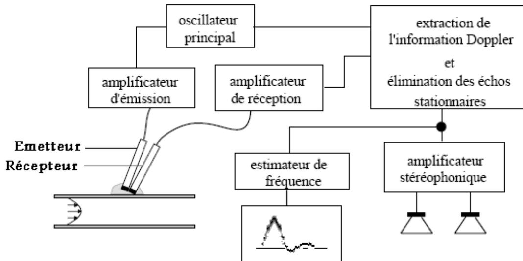
**Figure 3-1 :** Schéma de principe d'un vélocimètre à émission continue
