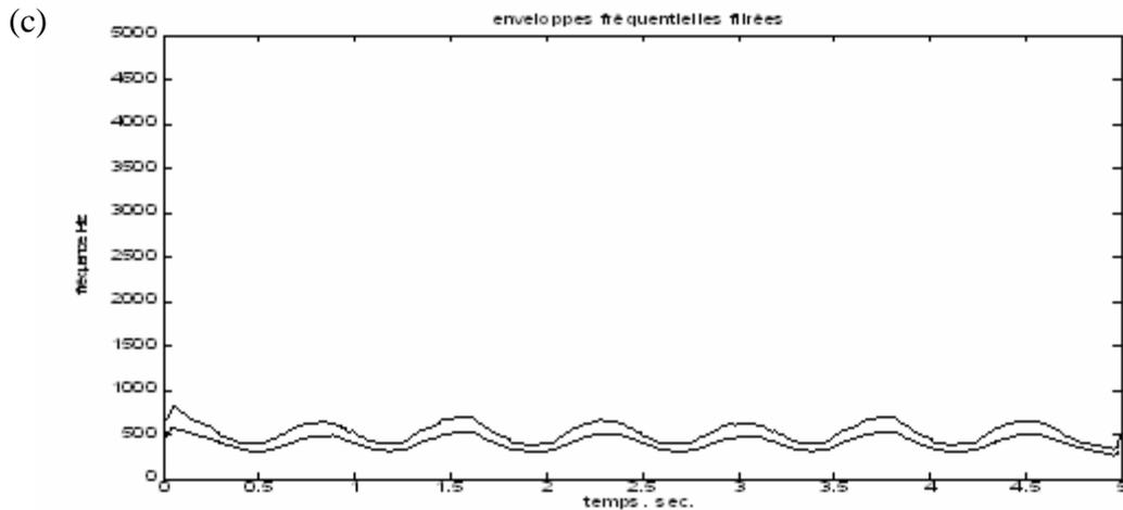
**Figure 5-4 :** Enveloppes fréquentielles maximales et moyennes obtenue par STFT et filtrée par un filtre moyennneur de: (a) 5 points , (b) 10 points, (c) 20 points.
