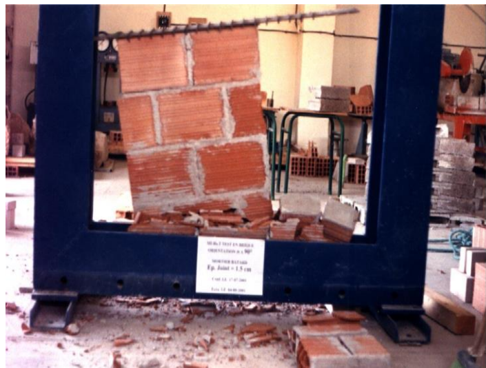
Photo 5.2 Rupture brusque des murets en brique de terre cuite ( \theta = 90^\circ )
