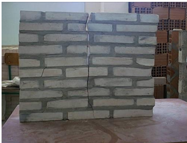
Photo 5.7 Mode de rupture des murets en silico-calcaire, modèle réduit ( \theta = 90^\circ )
