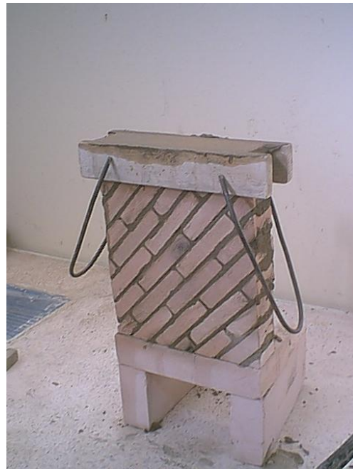
Photo 4.28 Opération de surfacage
