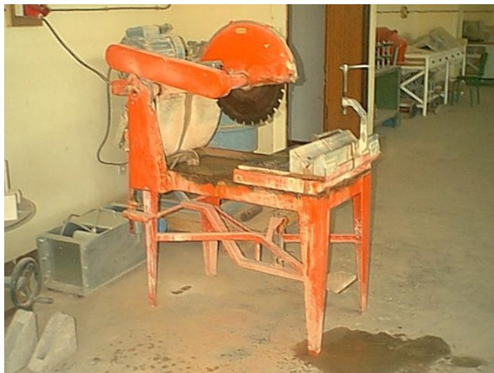
Photo 4.3 Scie à Béton
