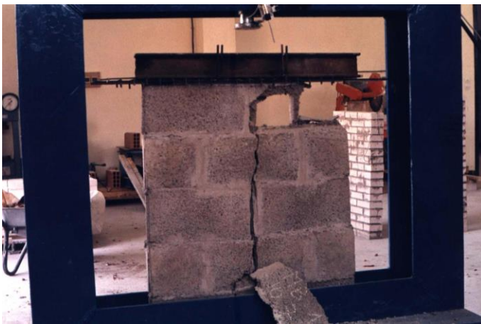
Photo 5.3 Mode de rupture du parpaing, mortier bâtard ( \theta = 90^\circ )
