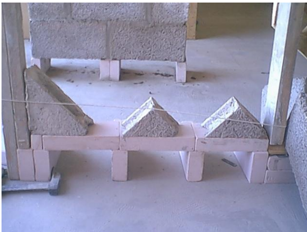
Photo 4.11 Dispositif pour la confection des murets
