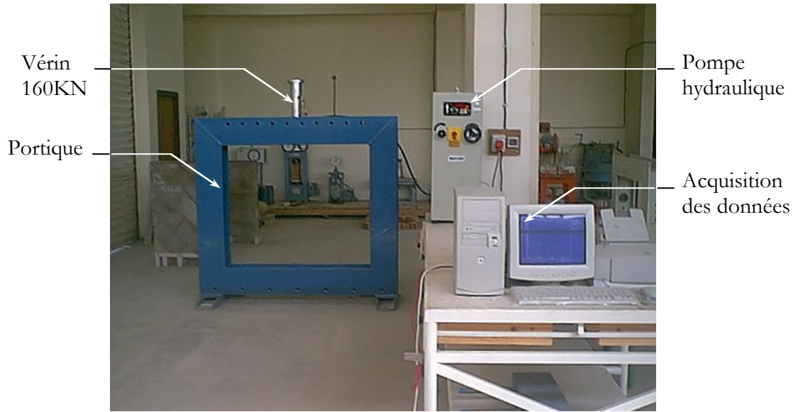
photo 4.29 L'ensemble du dispositif d'essai
