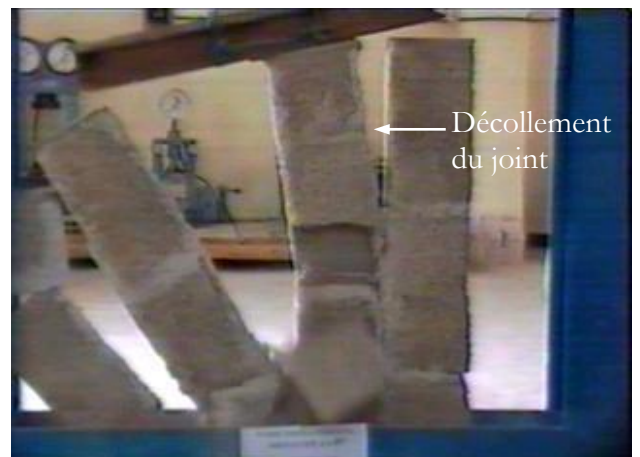
Photo 5.6 Mode de rupture du parpaing ( \theta = 0^\circ )
