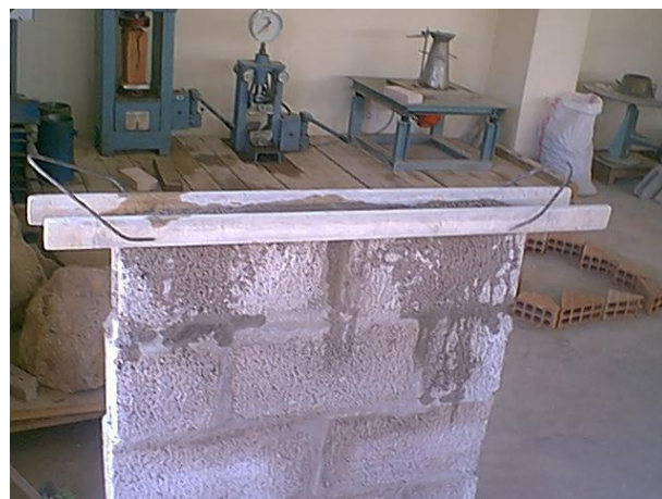
Photo 4.9 Opération de surfacage
