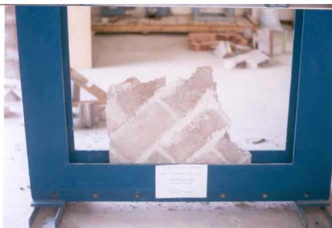
Photo 5.5 Mode de rupture du parpaing ( \theta = 45^\circ )
