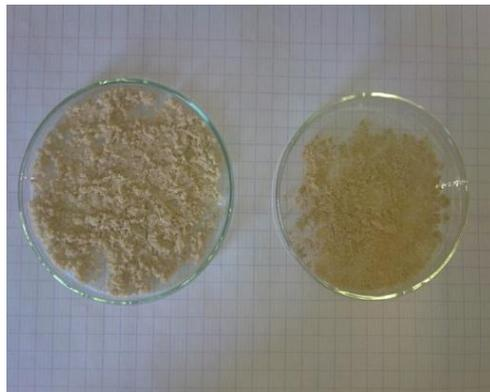
**Figure 9:** composite bentonite sodique-chitosane modifié par l'épichlorydrine après lavage
