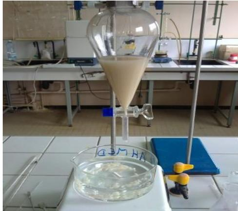
**Figure 5:** Système de précipitation du composite obtenu dans la solution de soude
