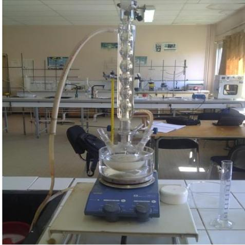
**Figure 8:** montage de la réaction de modification du composite bentonite sodique-chitosane par l'épichlorydrine
