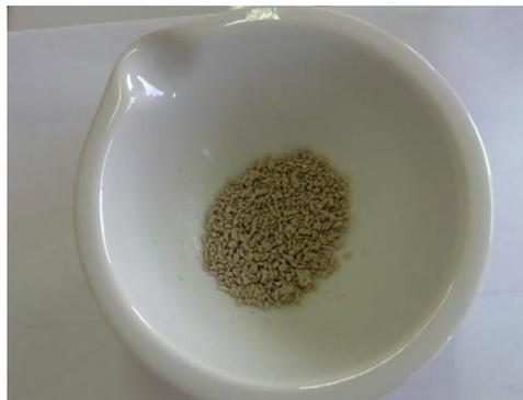
**Figure 10:** composite bentonite sodique-chitosane modifié par l'épichlorydrine après séchage
