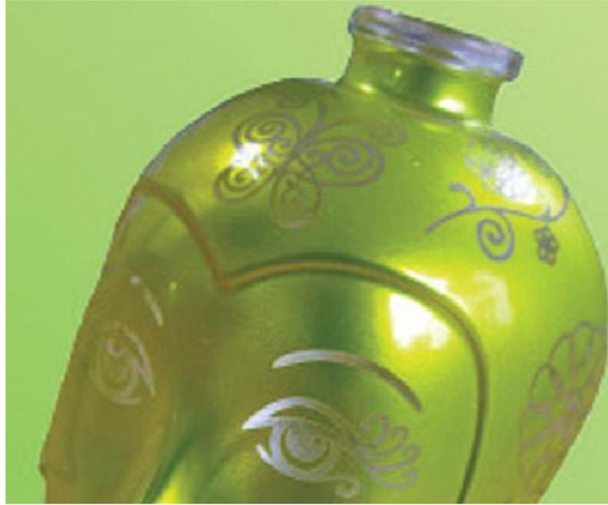
Figure II.11. Ablation laser sur flacon de parfumerie
