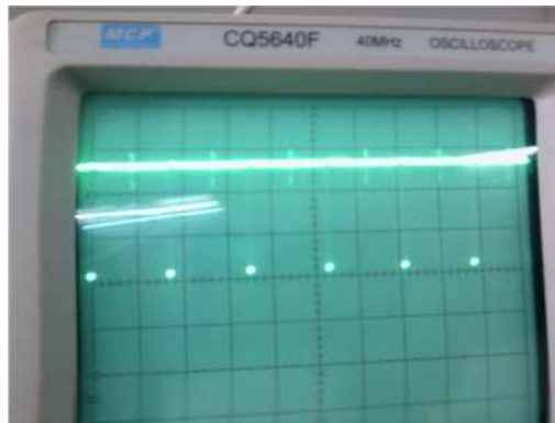
Figure 4.16 : l'impulsion de fin de conversion
