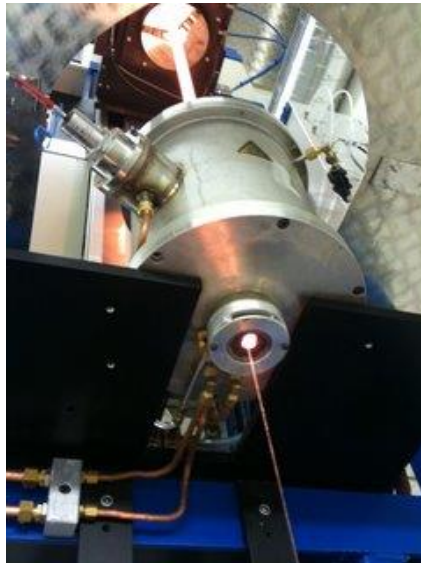
Figure 112 : Four inductif côté capillaires et cannes Système développé et réalisé à Xlim
