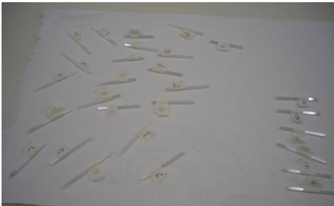
Figure 123 : Echantillon des cannes fabriqués après l'étirage de la préforme
