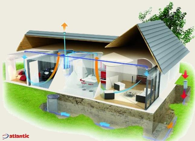
*En hiver, le sol à cette profondeur est plus chaud que la température extérieure : l'air froid est donc préchauffé lors de son passage dans les tuyaux. Avec ce système, l'air aspiré par la VMC ne sera pas prélevé directement de l'extérieur, d'où une économie de chauffage.*
