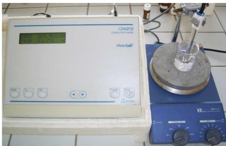
**Figure 3.** Conductimètre utilisé avec sa cellule électrolytique
