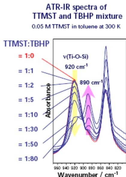
**Figure 12** : IR des mélange TTMST et TBHP
