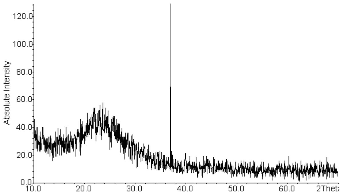
**Figure 17** : DRX de 2% TiO<sub>2</sub>-SiO<sub>2</sub> calciné 600°C
