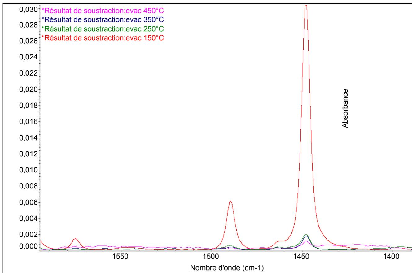
**Figure 19** : Infra rouge de l'adsorption de pyridine
