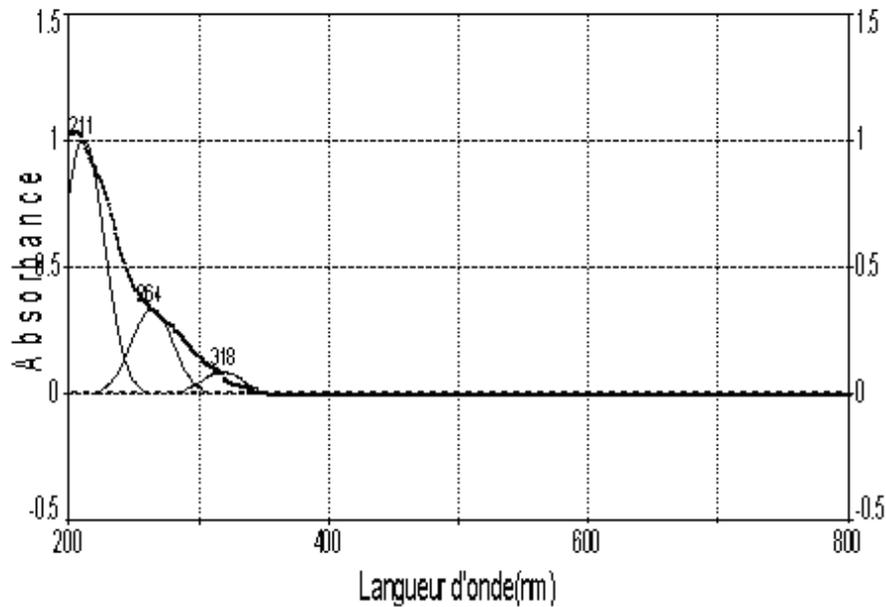
**Figure 5:** Déconvolution des pics d'UV-vis de 2%TiO<sub>2</sub>-SiO<sub>2</sub> calciné à 250 °C
