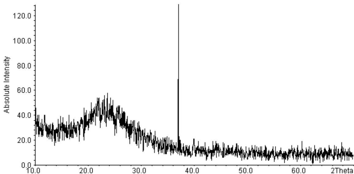
**Figure 13:** Spectre de DRX de 2% TiO<sub>2</sub>-SiO<sub>2</sub> calciné 400°C
