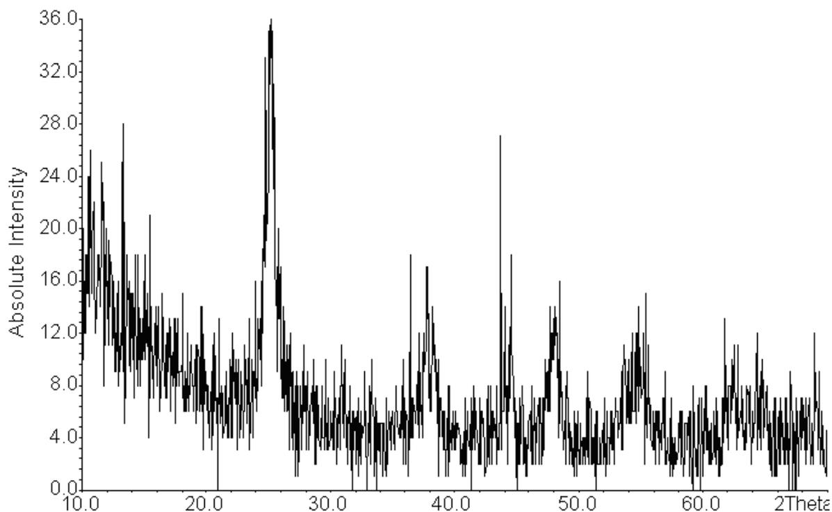
**Figure 2:** DRX de TiO<sub>2</sub> calciné à 500 °C
