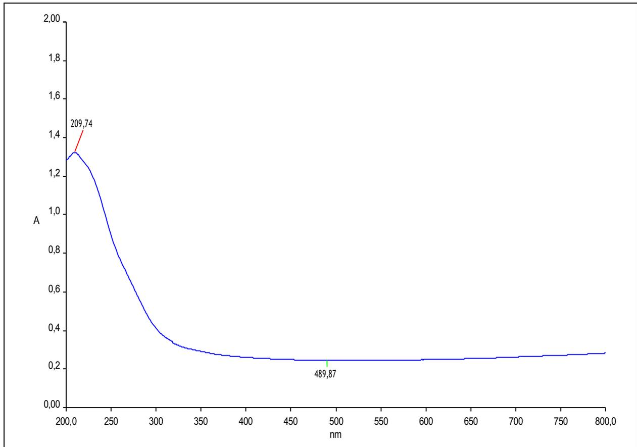
**Figure3** : UV-vis de 2% TiO<sub>2</sub>-SiO<sub>2</sub> calciné à 250 °C séché.
