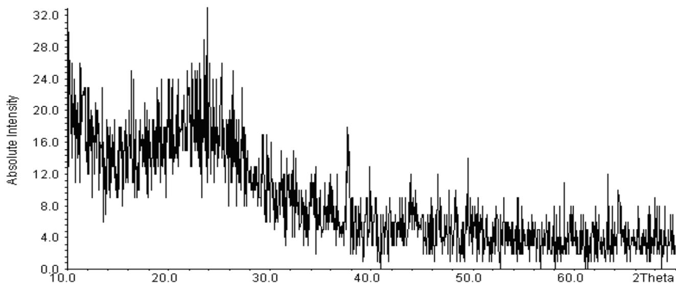
**Figure 7 :** Spectre DRX de 2% TiO<sub>2</sub>-SiO<sub>2</sub> calciné à 250 °C
