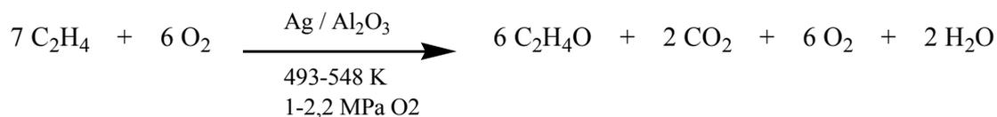
**Figure 8 :** Réaction d'époxydation d'éthylène par le procédé de Lefort
