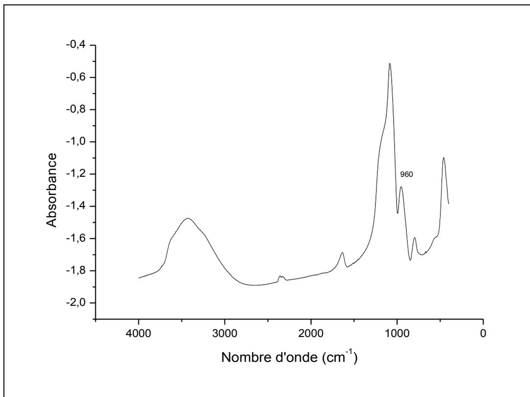
**Figure 11**: FTIR de 2% TiO<sub>2</sub>-SiO<sub>2</sub> calciné à 400 °C
