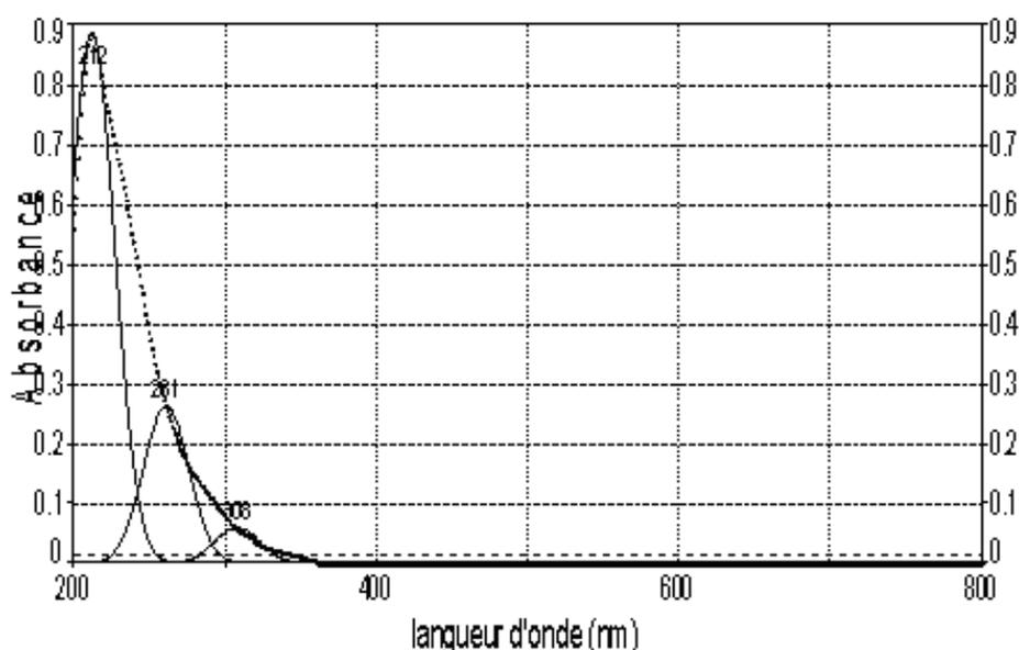
**Figure 12:** Déconvolution des pics UV-vis de 2%TiO<sub>2</sub>-SiO<sub>2</sub> calciné à 400°C
