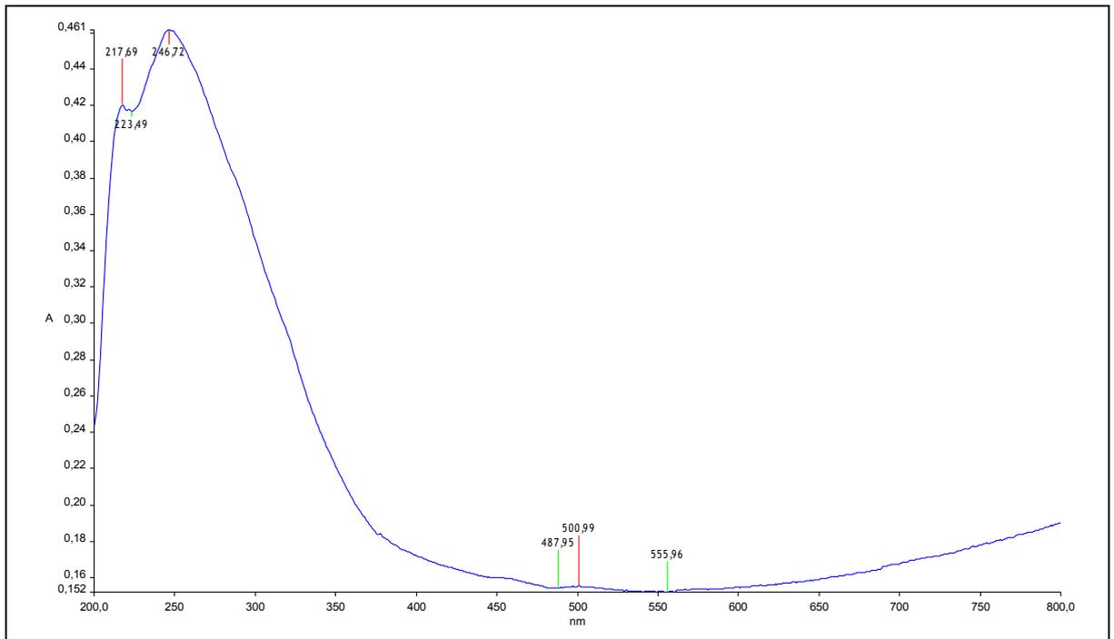
Figure 14 : Spectre UV-vis de 2% TiO<sub>2</sub>-SiO<sub>2</sub> calciné 600°C
