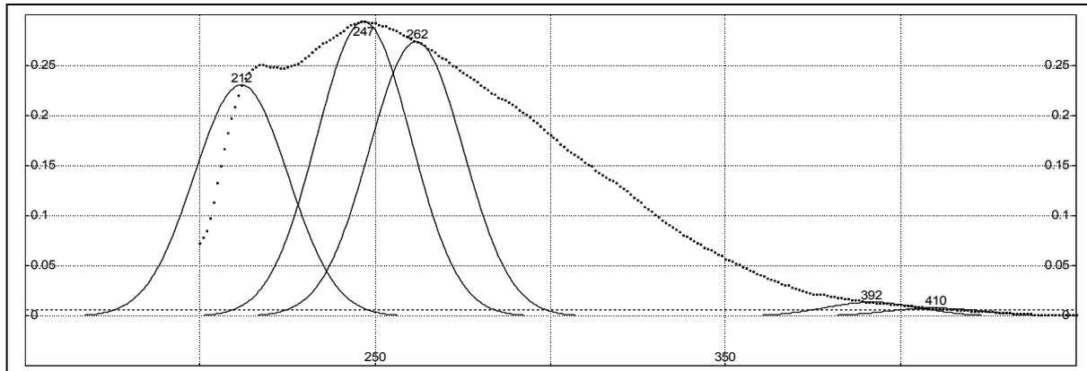
**Figure 16 :** Déconvolution des pics d'UV-vis de 2% $\text{TiO}_2\text{-SiO}_2$  calciné à 600 °C
