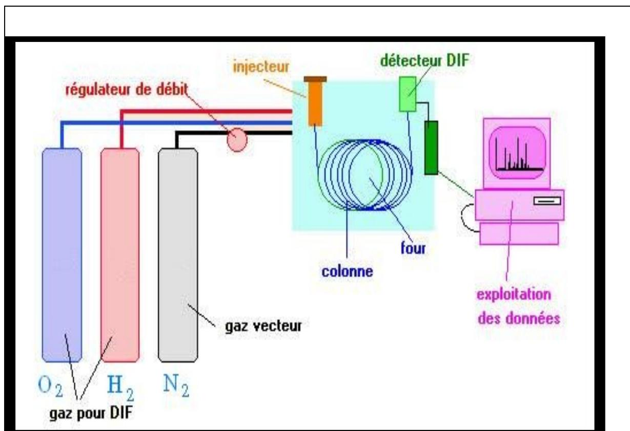
**Figure 2:** Schéma simplifié d'un chromatographe en phase gazeuse
