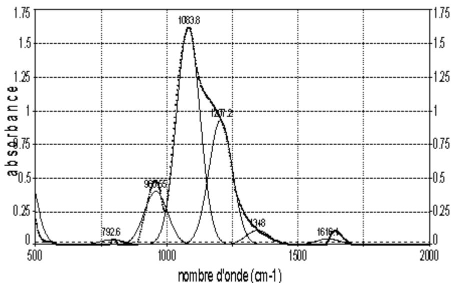
**Figure 9** : La déconvolution des pics FTIR du 2%  $\text{TiO}_2\text{-SiO}_2$
