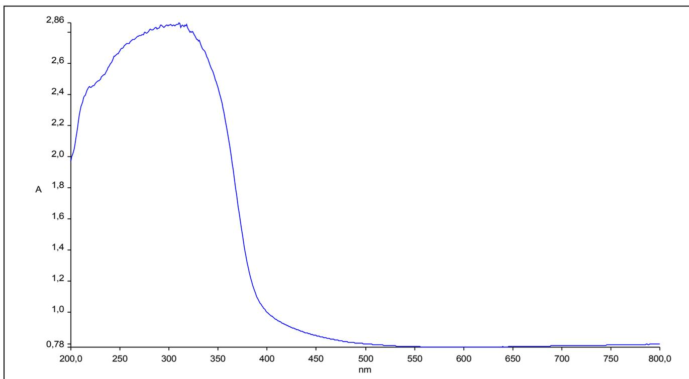
**Figure 1** : UV-vis de  $\text{TiO}_2$  calciné à  $500\text{ }^\circ\text{C}$
