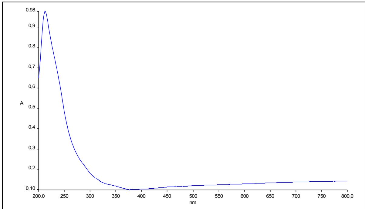
**Figure 10** : UV-vis de 2% TiO<sub>2</sub>-SiO<sub>2</sub> calciné 400°C
