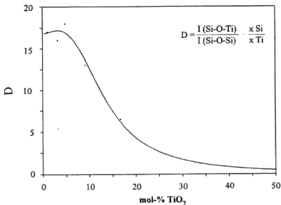
**Figure 9 :** Influence de la teneur de TiO<sub>2</sub> sur la dispersion de Si-O-Ti
