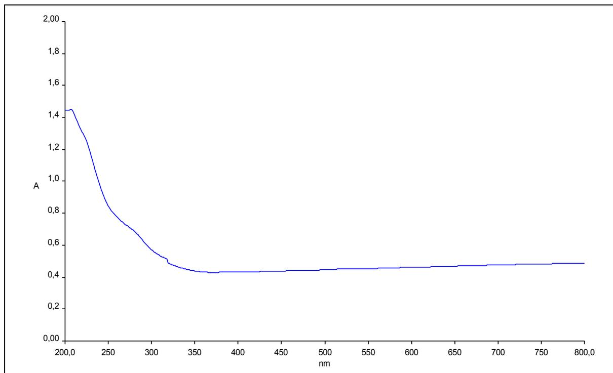
**Figure 4** : UV-vis de 2% TiO<sub>2</sub>-SiO<sub>2</sub> calciné à 250 °C humidifié.
