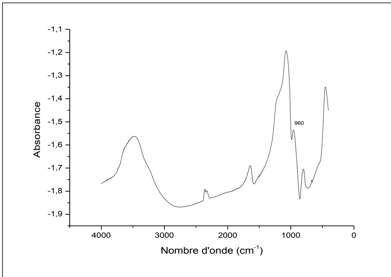
Figure 15 : Spectre FTIR de 2% TiO<sub>2</sub>-SiO<sub>2</sub> calciné 600°C
