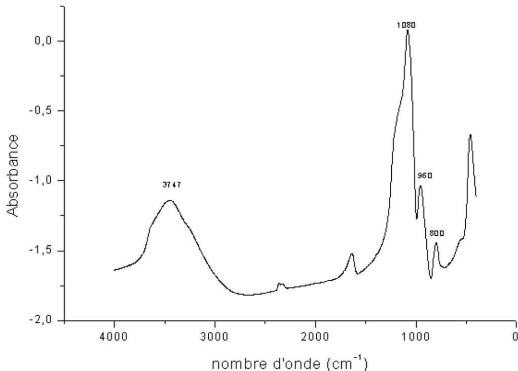
**Figure 6 :** FTIR de 2% TiO<sub>2</sub>-SiO<sub>2</sub> calciné à 250 °C
