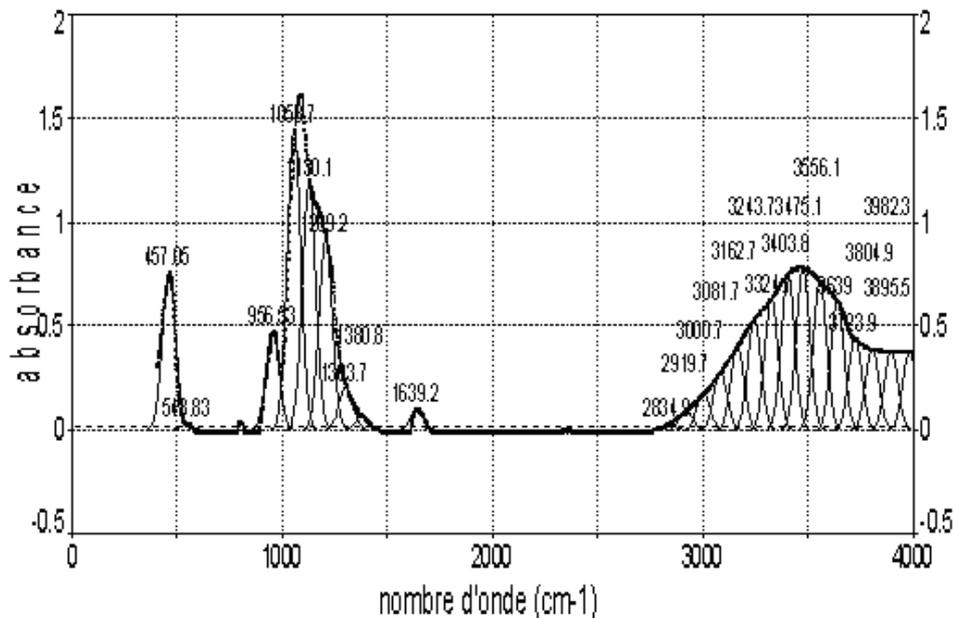
**Figure 8** : La déconvolution des pics FTIR du 2% TiO<sub>2</sub>-SiO<sub>2</sub>
