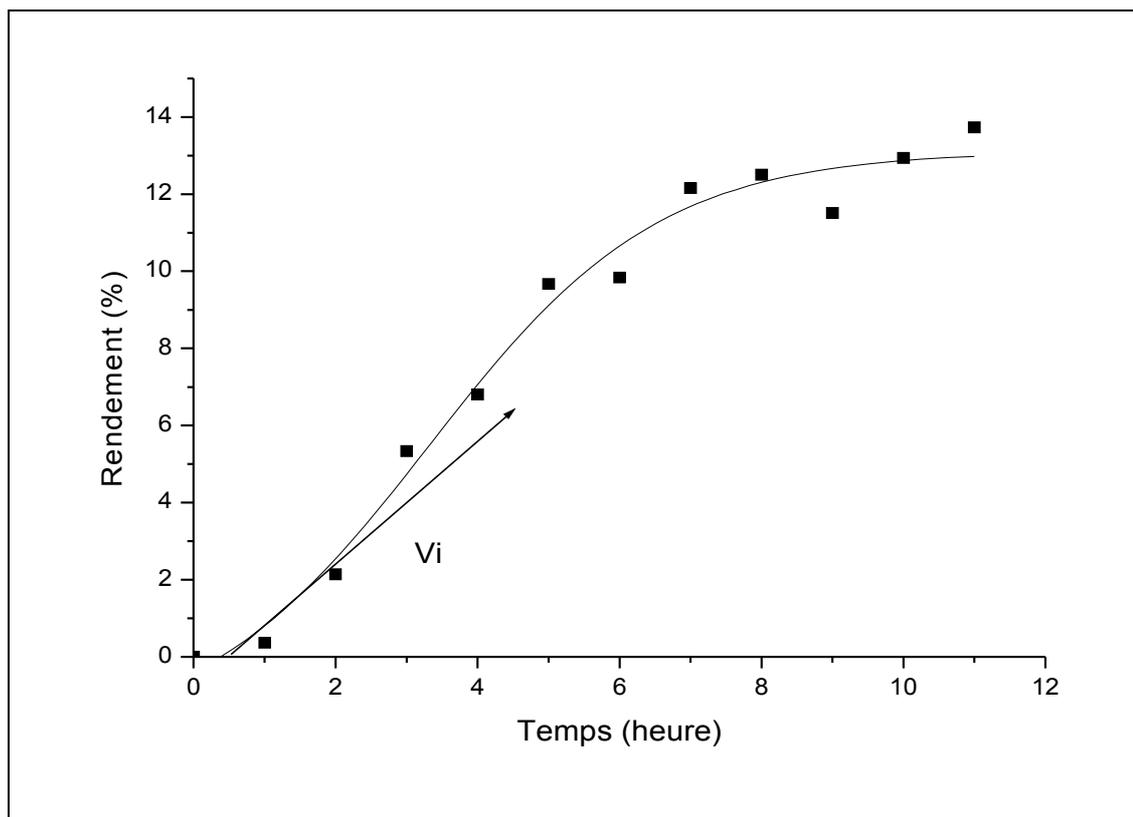
**Figure 18** : Cinétique de l'époxydation du cyclohexène dans le décane par 2% TiO<sub>2</sub>-SiO<sub>2</sub> calciné à 250 °C
