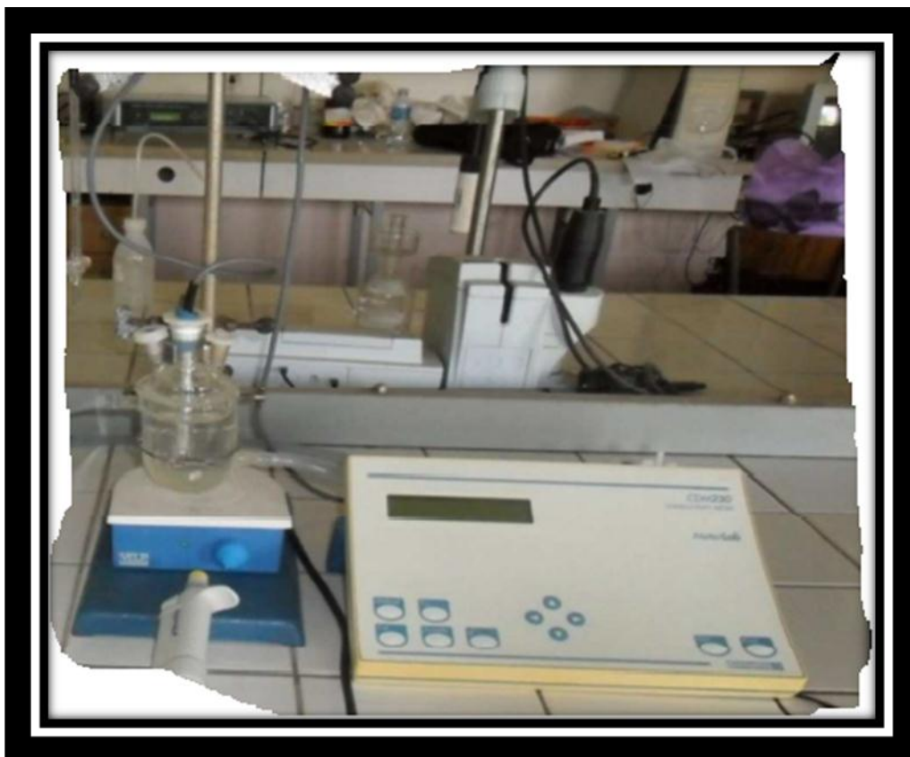
Figure 6 : Dispositif de mesures de la conductivité
