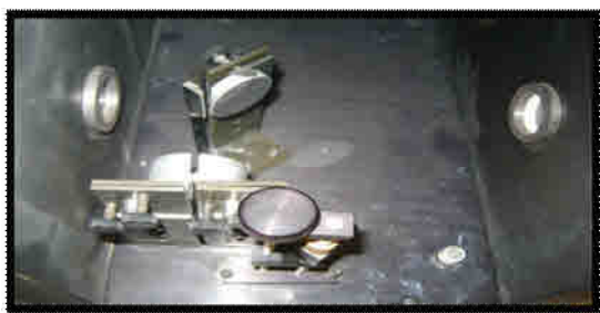
Figure 2 : Schéma du système utilisant la réflexion diffuse
