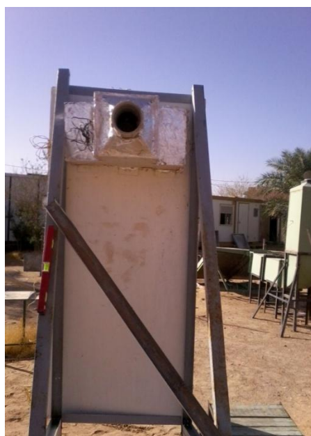
Figure IV.7: La partie d'aspiration.
