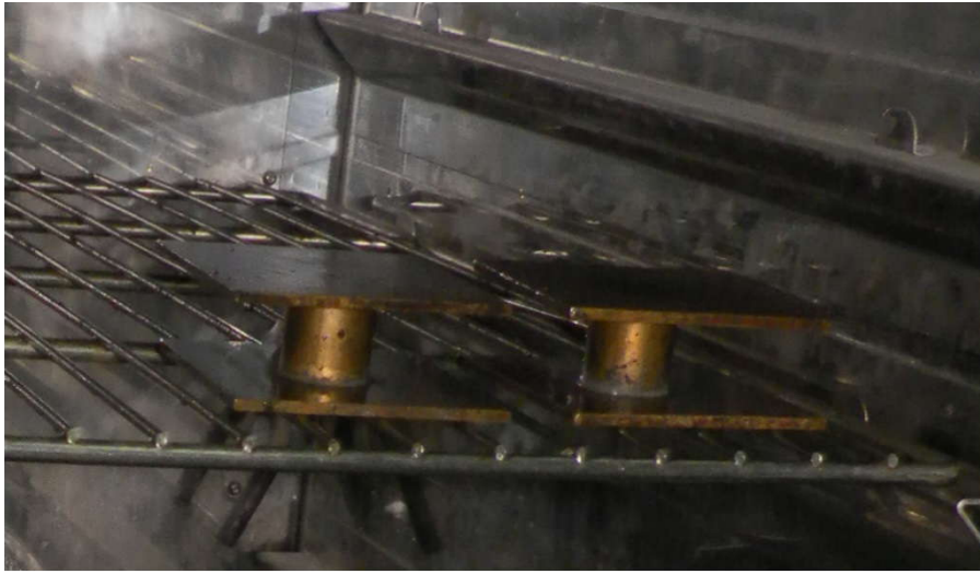
Figure 2.7 : Préparation et conservation d'aiguille de Le Chatelier [23]
