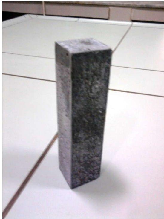
Figure 4.4 Une éprouvette après 170 jours dans l'eau de mer [23]
