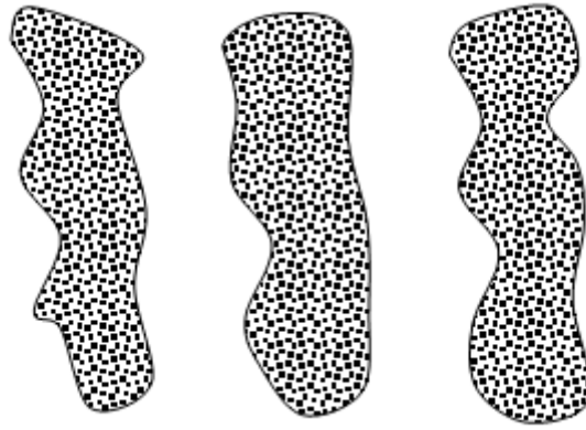
Figure I 21: Représentation de la structure du silicium macroporeux ( \emptyset des pores \sim 0,1 à 1 \mu m )
