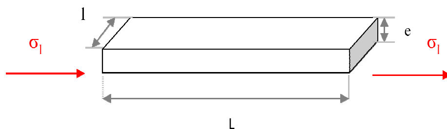
Figure C.1: barreau semiconducteur soumis à une contrainte longitudinale.
