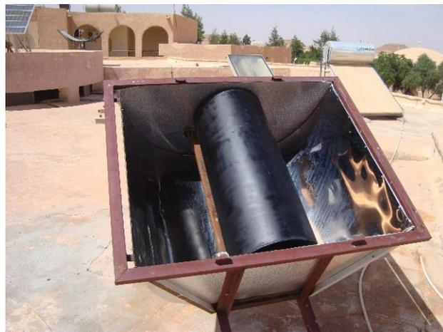
**Figure 4.3 :** Dispositif avec miroir CPC et cuve de stockage
