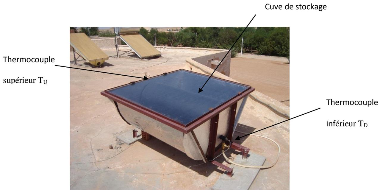
**Figure 4.8 :** Disposition des deux thermocouples sur la cuve de stockage.
