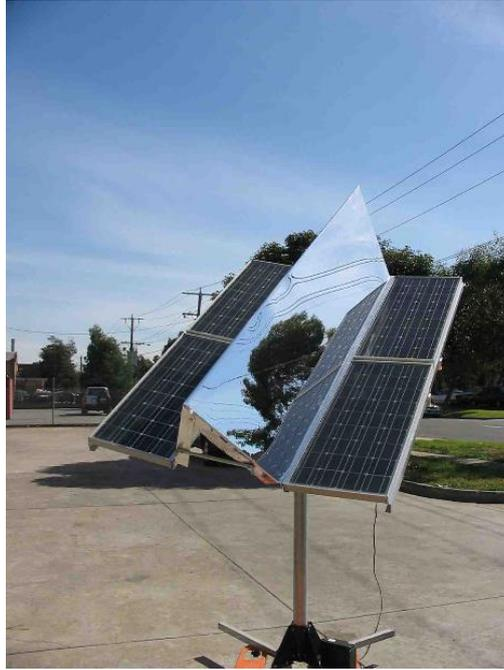
**Figure 1.20** : Panneau solaire photovoltaïque avec miroir plan.
