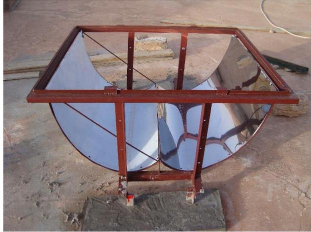
**Figure 4.2 :** Structure métallique robuste avec miroir CPC
