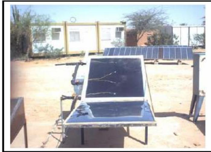
**Figure 2.17 :** Vue générale du capteur stockeur d'Adrar.
