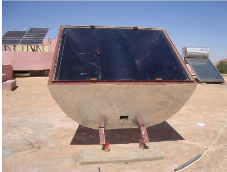
**Figure 2.19 :** Vue générale du capteur stockeur que nous avons réalisé à Ghardaïa
