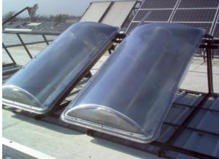
**Figure 2.9 :** Capteur stockeur « sunflow » [8]
