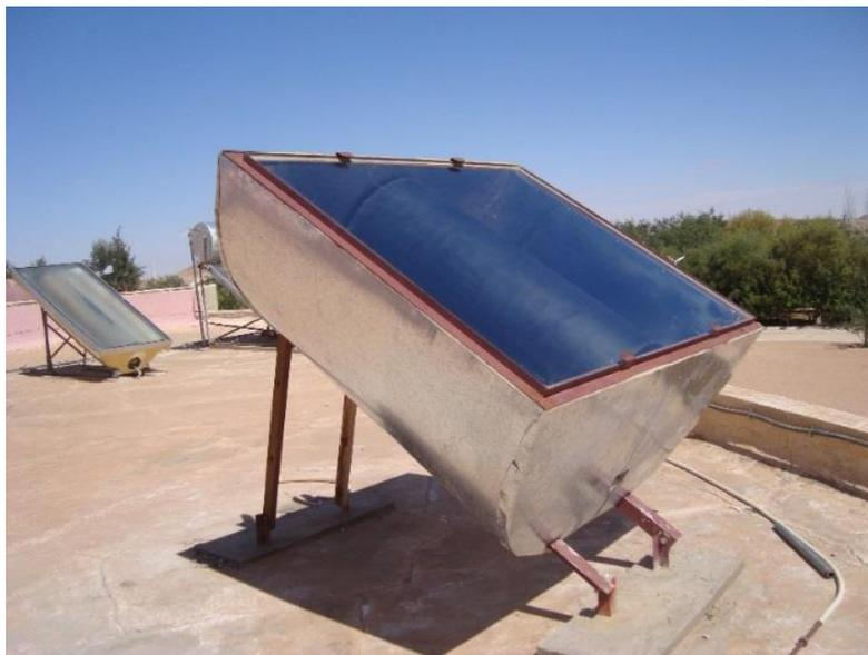
**Figure 4.20** : Photo du capteur stockeur réalisé à URAER Ghardaïa (CS2)
