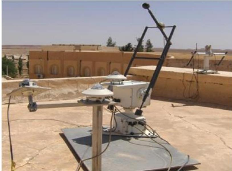
**Figure 4.9 :** Station Sun-Tracker installée à l'URAER, Ghardaïa.
