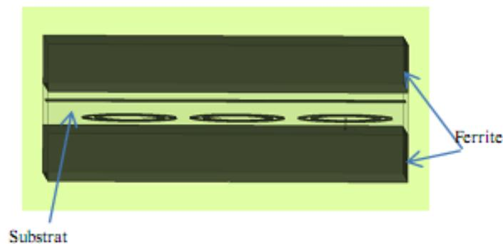
Figure IV.12: Structure d'un filtre stop bande réglable avec trois SRR - fils et double couche de ferrite
