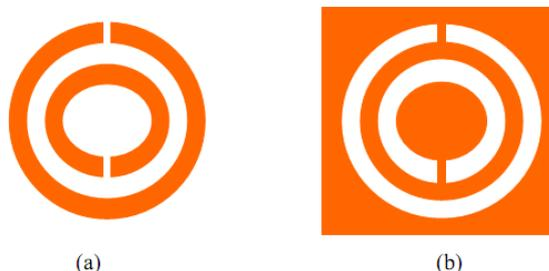
Figure II.1: Topologie de (a) SRR et (b) CSRR .
