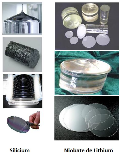
Figure I-8 : illustrant les lingots de silicium et de niobate de lithium ainsi que leurs plaquettes respectives
