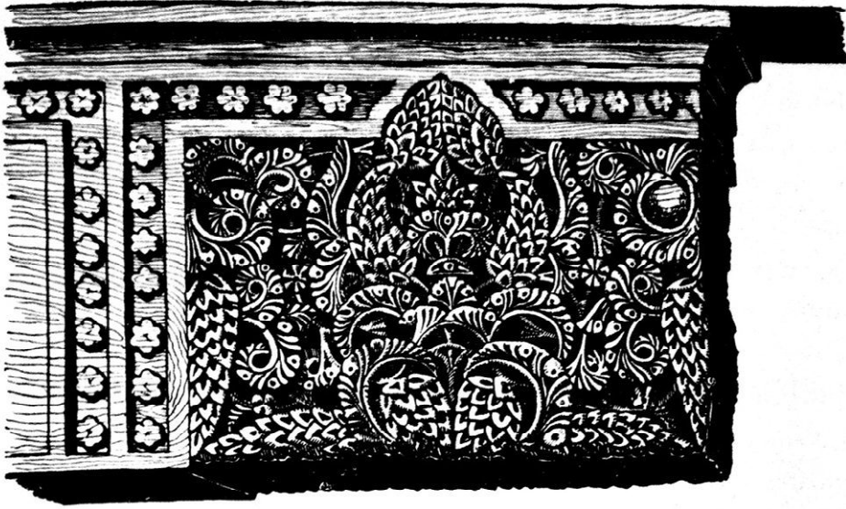
شكل رقم 15 : احد الكوابل الخشبية التي تحمل العوارض الخشبية لأروقة مدرسة الصّهريج (عن J. Hainaut)
