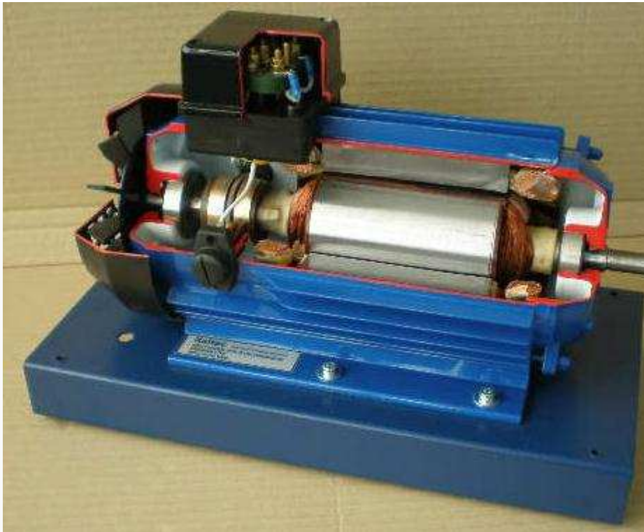
Figure I.1 : Machine triphasée, le rotor est alimenté en courant continu.
