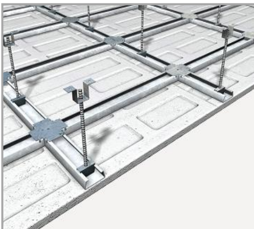
Figure 70: Fixation du faux plafond.
