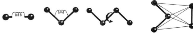
FIGURE 2.1 – Composantes du Champ de Force. De gauche à droite : Déformations des liaisons, angles, dièdres et interactions non-liées.
