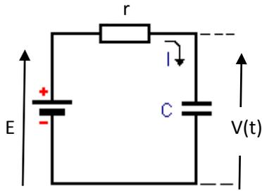
Soit  $I(t)$  le courant circulant dans le circuit à l'instant  $t$ . Les électrons circulent en sens inverse, ils quittent l'armature supérieure qui se charge alors positivement pour aller sur l'armature inférieure qui se charge négativement. Soit  $q(t)$  et  $v(t)$  respectivement la charge du condensateur et la tension à ses bornes :
