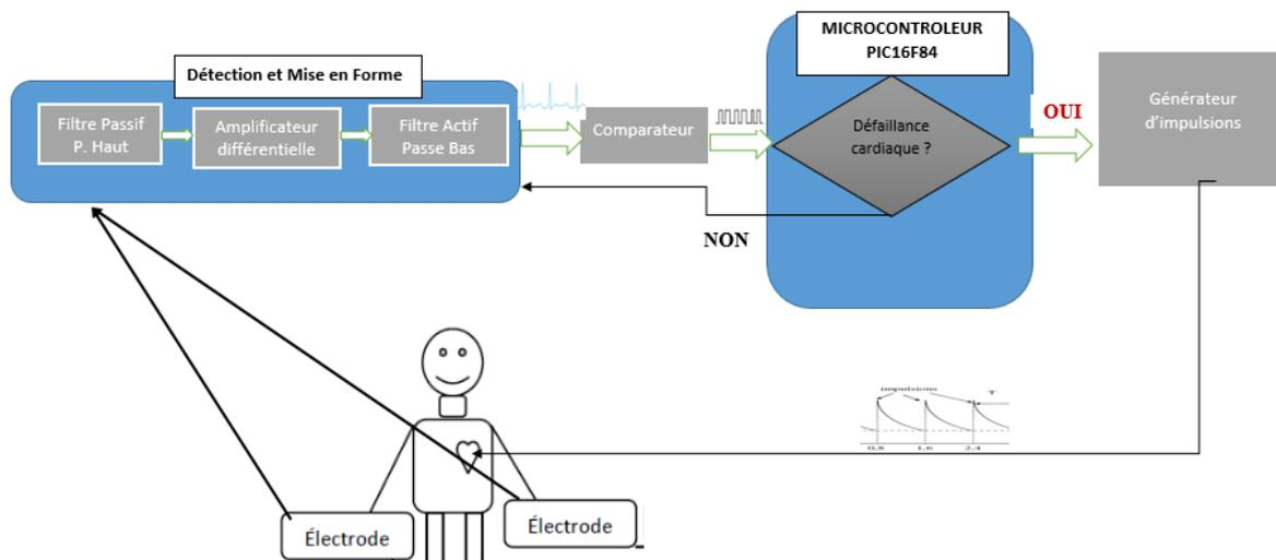
*Schéma bloc du Prototype réalisé*
