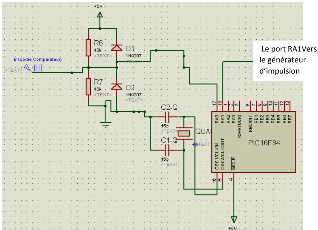
Figure IV. 18 Circuit Electrique d'automatisation du stimulateur cardiaque
