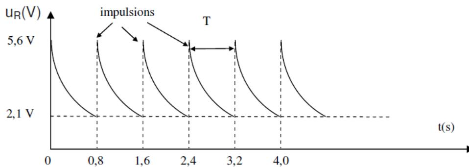
Figure IV.13 L'allure de  $U_R (t)$  et impulsions électriques
