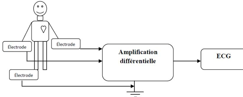
Figure IV.6 Schéma bloc d'un électrocardiographe
