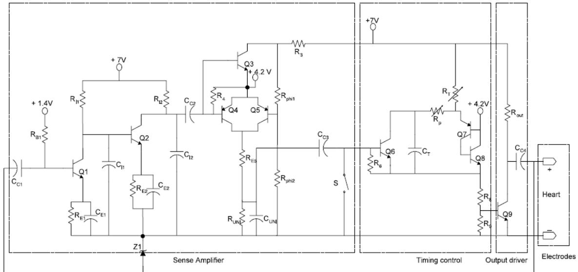
Figure III.7 Schéma électrique du pacemaker à la demande de Berkovits
