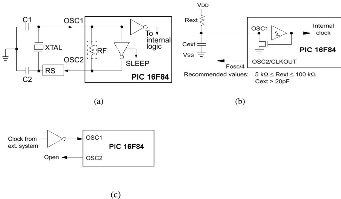
Figure IV.3. Les différentes configurations de l'oscillateur du 16F84
