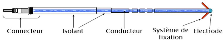
Figure III.9. Vue d'ensemble d'une sonde d'un pacemaker [7]
