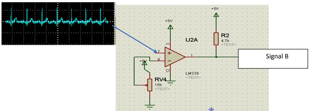
Figure IV.9 Etage de comparaison
