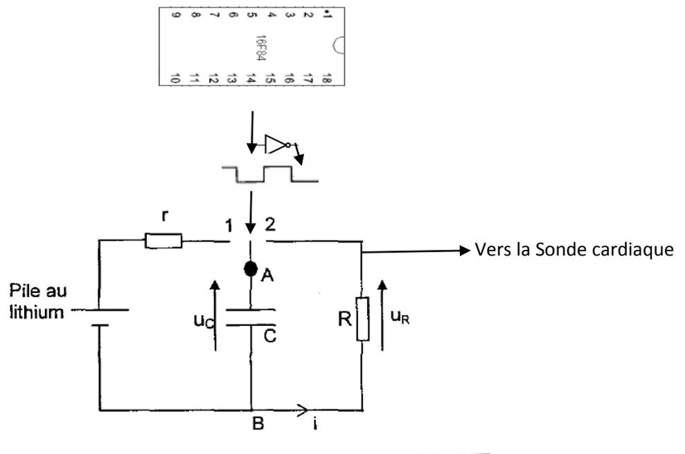
Figure IV.14. Schéma synoptique d'un stimulateur cardiaque microcontrôlé
