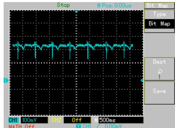
Figure IV.20 : sortie U3(2) du module ECG
