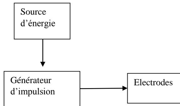
*Figure III.3 Schéma fonctionnel de base d'un pacemaker [5]*
