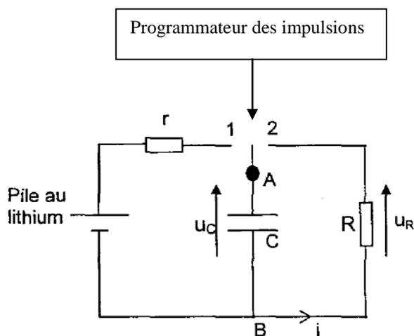
Figure IV.10 Schéma simplifié d'un stimulateur
