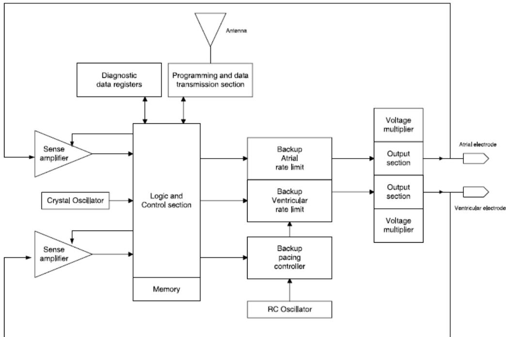
Figure III.8 Schéma synoptique d'un stimulateur cardiaque moderne
