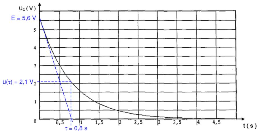
Figure IV.12 Evolution de la tension  $U_C$  aux bornes du condensateur
