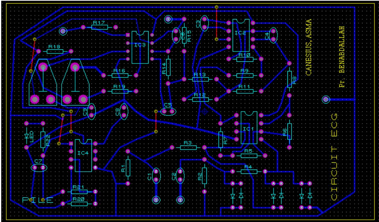
Figure IV.8 Circuit imprimé et implantation des composants de l'ECG
