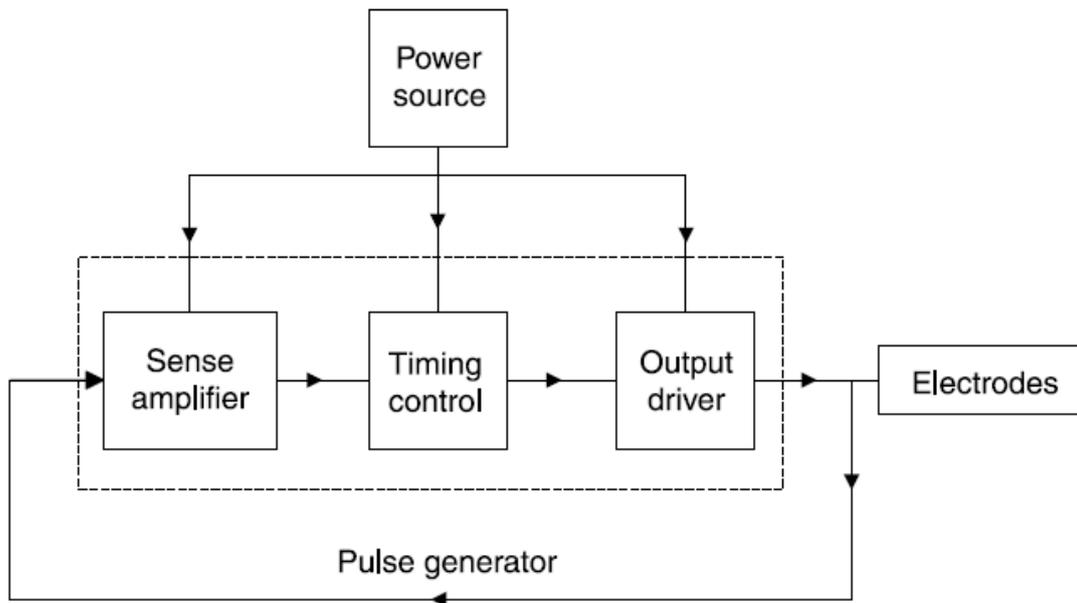
Figure III.6 Schéma synoptique du pacemaker à la demande
