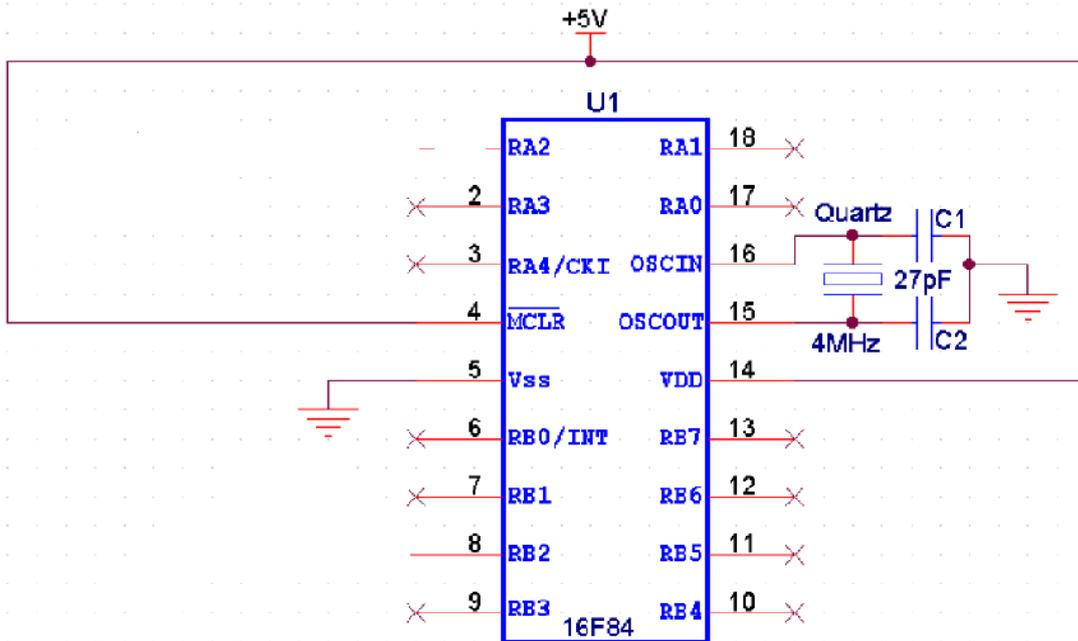
Figure IV.15. Pilotage et connexion du PIC 16F84
