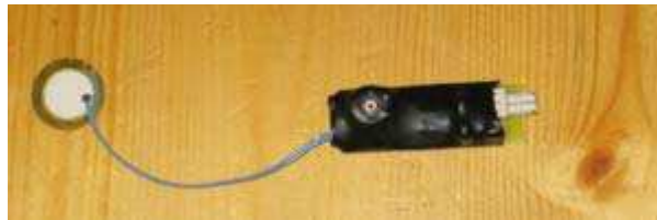
Figure 14 : Capteur piézoélectrique accompagné de son montage d'amplification avec potentiomètre de réglage.
