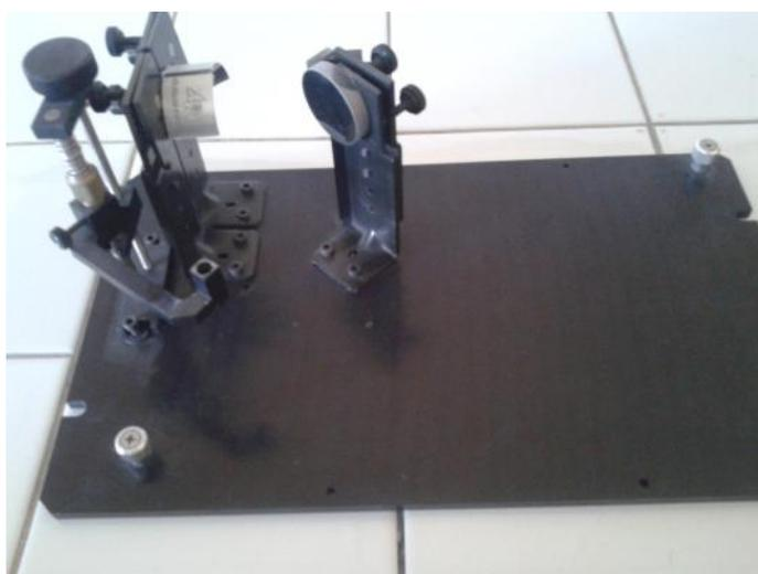
**Figure II-6 :** Accessoire de réflexion diffuse pour l'UV-Visible du solide
