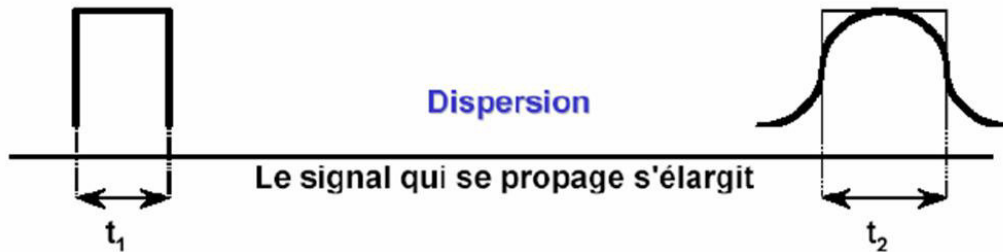
Figure 2.6. L'effet de la dispersion chromatique sur une impulsion
