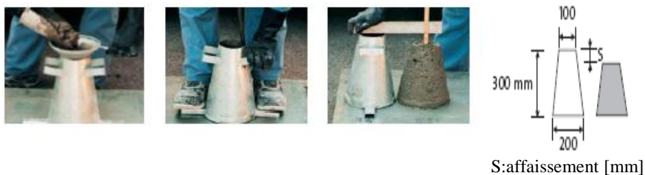
Figure I. 6: Essai d'affaissement
