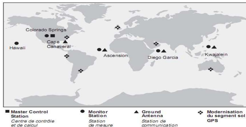
Figure2.4: répartition des secteurs de contrôle GPS
