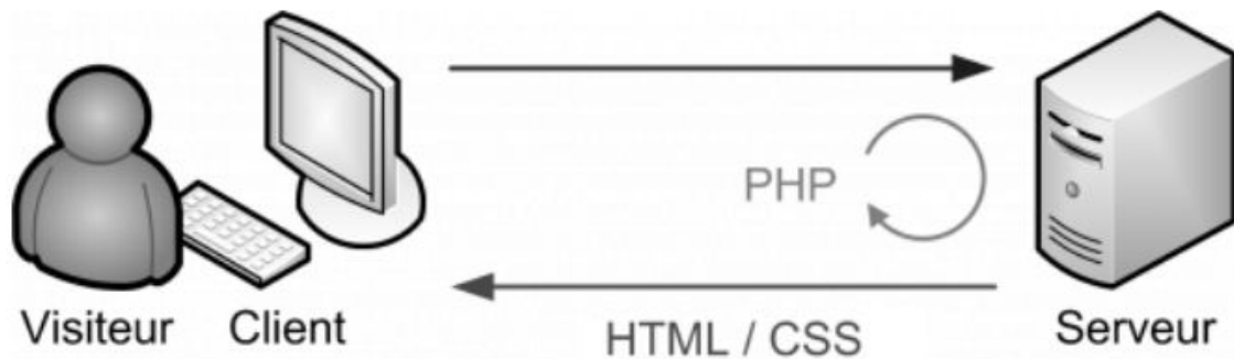
Fig4.8: Principe de fonctionnement d'un serveur Web
