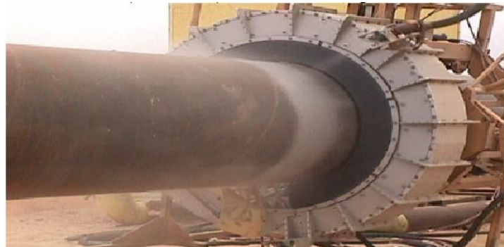
Figure 2.19 : Machine de sablage automatique.STT
