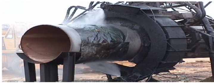
Figure 2.20 Revêtement d'un tube par le polyéthylène (STT).
