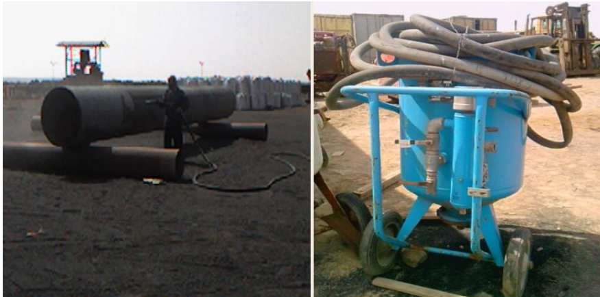
Figure II.7 : Sableuse manuelle (STT)
