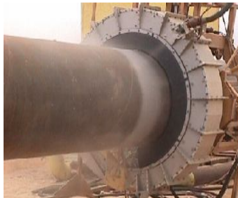
Figure II.5 : Sableuse automatique (STT)
