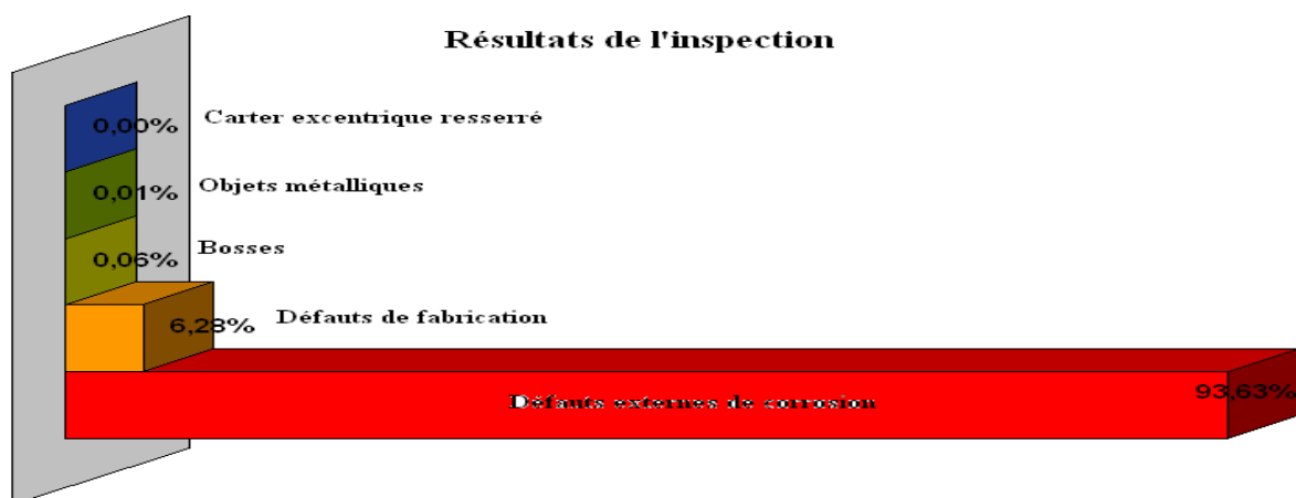
Figure 2.8 : Résultats d'inspection par Magne Scan RH. DRC
