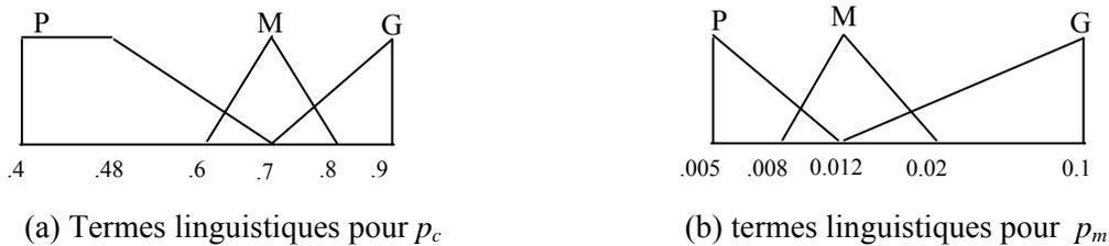
Fig. 1.15 Fonctions d'appartenance des variables de sortie du contrôleur flou.
