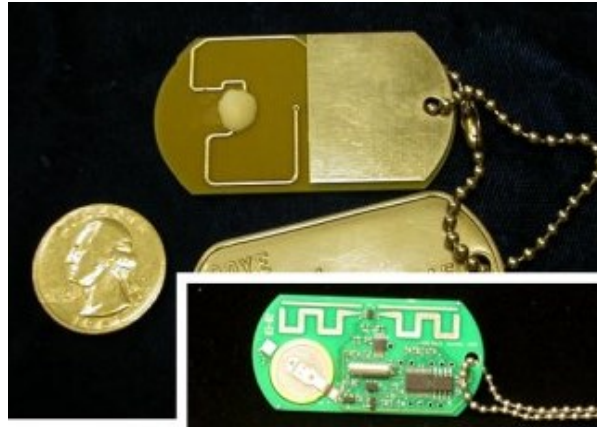
Figure II-11 : Exemple de tag RFID semi passif
