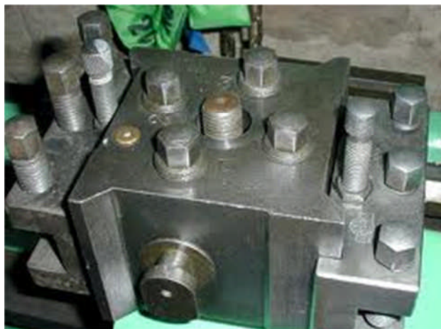
Figure 1.6. Tourelle avant et arrière [6]
