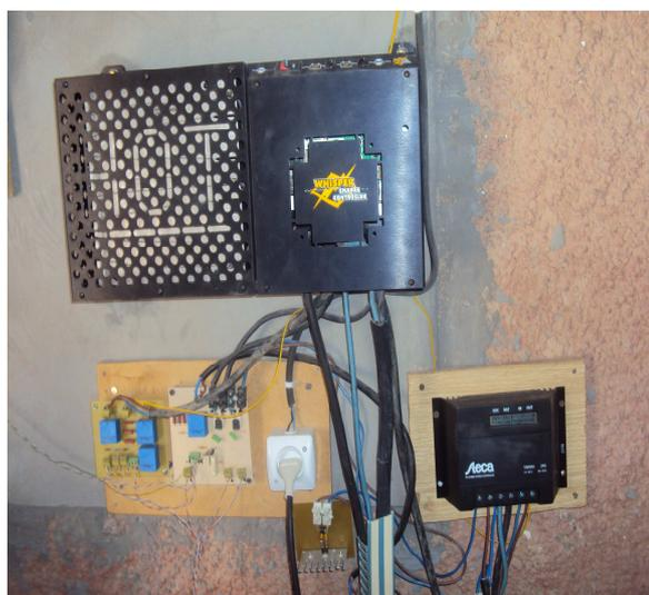
Fig. 25 : Photo du contrôleur Whisper et du contrôleur de charge et de décharge des batteries
