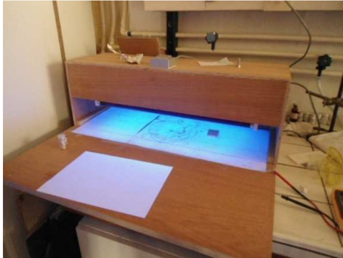
Figure III.2 : Dispositif de photo-polymérisation UV
