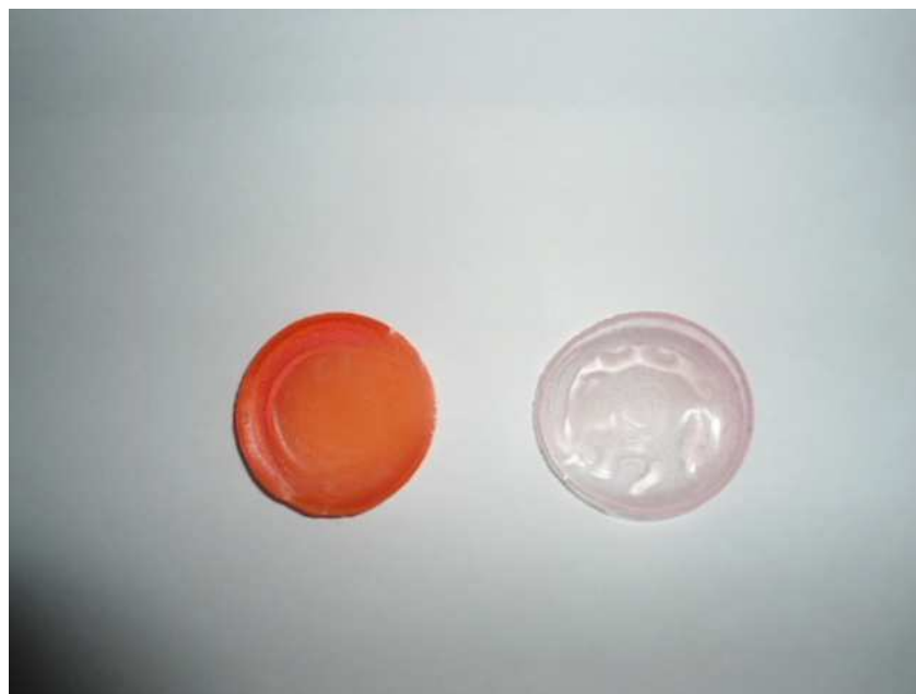
Figure III.18 : Photographie d'un réseau de poly(HEMA) réticulé à 0.7% de HDDA après l'étape de polymérisation et après lavage en éthanol.
