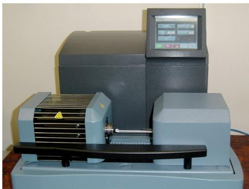
**Figure II-8 : Appareil d'analyse thermique SDT Q600.**
