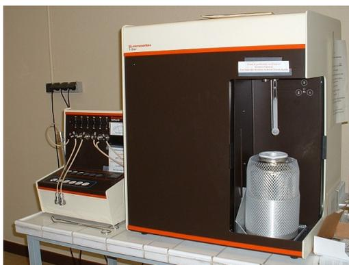
**Figure II-9 : Photo de l'appareil Micromeritics Tristar 3000**
