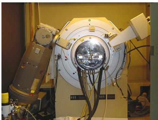
Figure II-7 : diffractomètre D5005 (Bruker)
