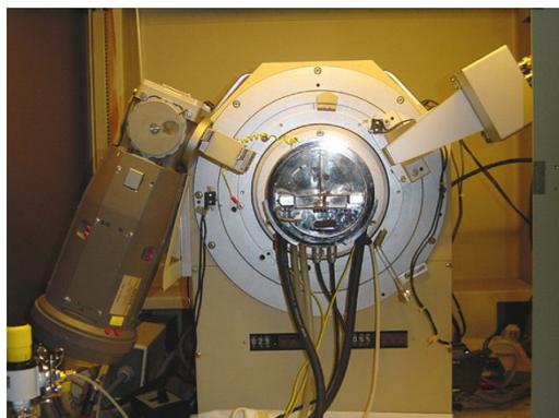
Figure II.2 : photo de diffractomètre D5005 (Bruker)
