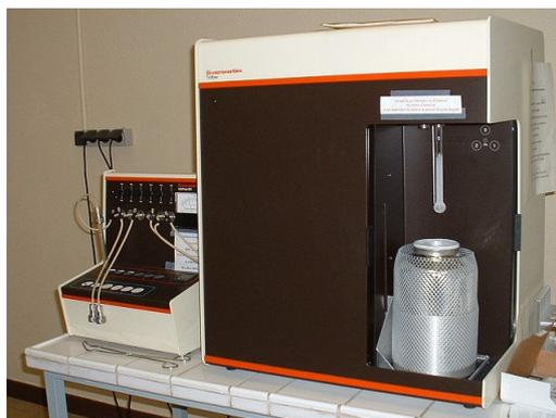
Figure II.5 : Photo de l'appareil Micromeritics Tristar 3000
