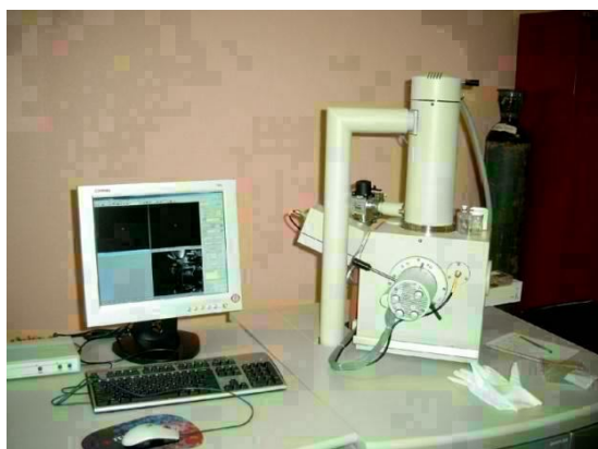
Figure 2. 10 : Photographie du MEB ((Marque FEI, modèle QUANTA 200 environmental MEB environmental filament de tungstène. Pression : 20Kv, spot 2.0).
