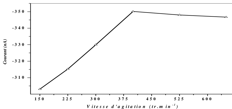
Figure IV.1.7. Influence de la vitesse d'agitation sur l'intensité du pic de cuivre (II). Conditions: HClO 4 0,03 M, Cu (II): 75 ng mL -1 , HBS : 7,5×10 -5 M, temps d'accumulation 50 s, potentiel d'accumulation -350 mV (vs. Ag/AgCl).
