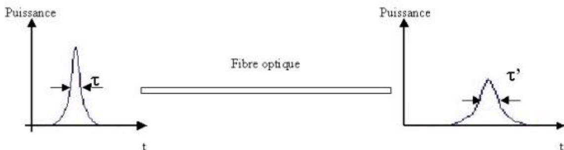
**Figure (2.6)**- Evolution de l'impulsion pendant sa propagation dans la fibre optique [2.5]
