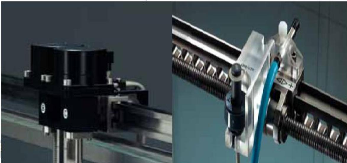
Figure 4.4: Moteur piloté pour le déplacement du détecteur.
