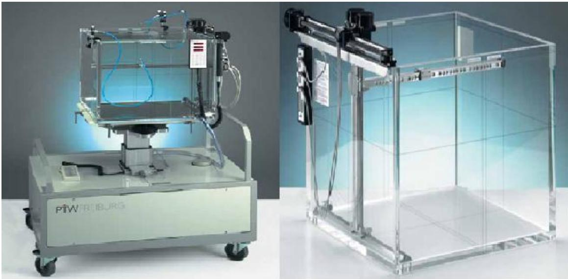
Figure 4.3: Fantômes d'eau de type PTW MP3.
