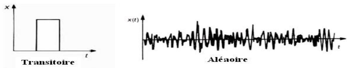
Figure.2.1: Exemple d'un signal transitoire et aléatoire
