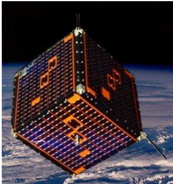
Figure 1.2 : Panneaux solaires fixés directement sur la structure du satellite (NASA).
