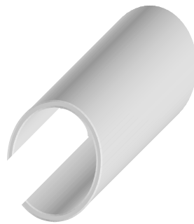
Figure 1.13 : Tube cylindrique à section ouverte du satellite OGO-IV.
