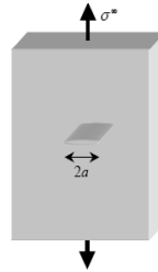
Figure I.5: Fissure de longueur 2a dans une plaque infinie
