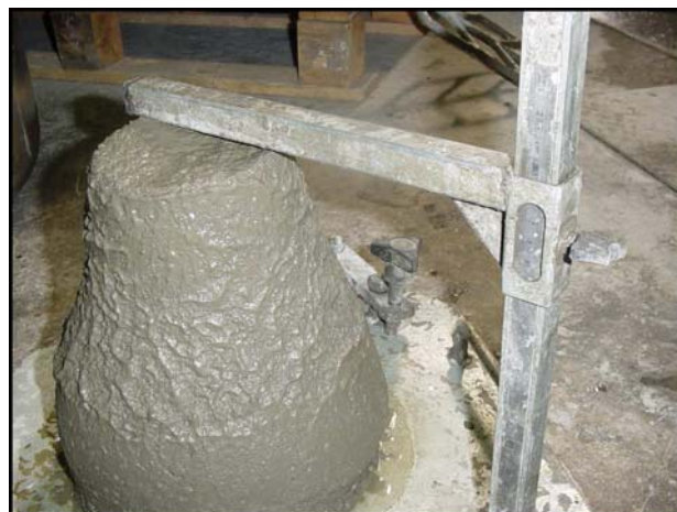
Figure 5.3 : Mesure de l'affaissement du béton au cône d'Abrams (Affaissement égal à 6,8 cm)
