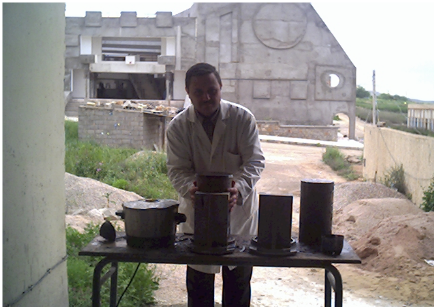
Figure 5.6 : Appareil de surfaçage des éprouvettes
