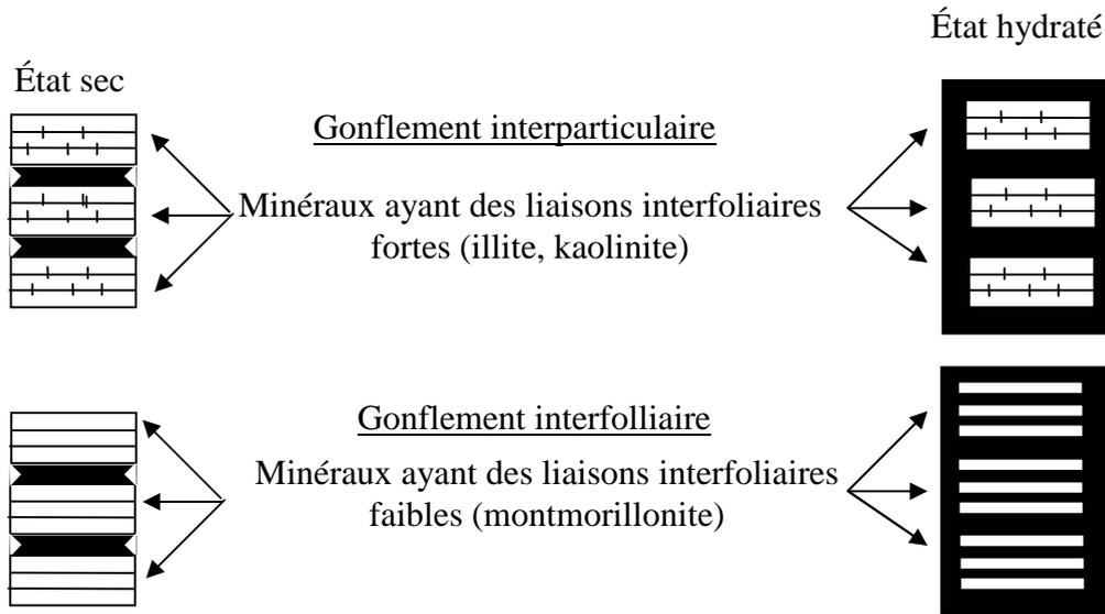
Figure I.6 : Mécanismes de gonflement des argiles par hydratation.
