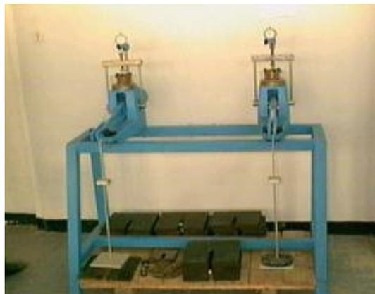
Figure III. 27 : Cellule œdométrique
