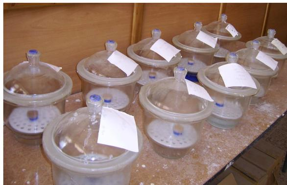
Figure IV.49 : Batterie de dessiccateurs (Sayad-Gaidi, 2003)
