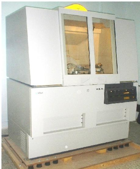
Figure III.3 : Diffractomètre X'PERT PRO
