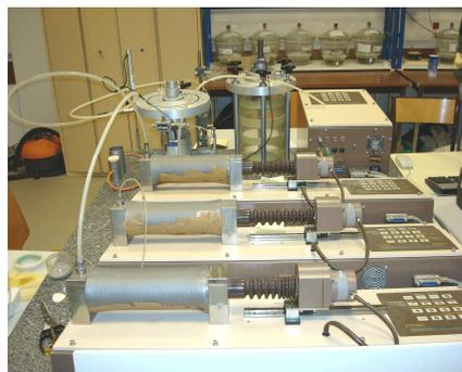
Figure IV.2 : Cellule triaxiale pilotée par des contrôleurs pression- volume
