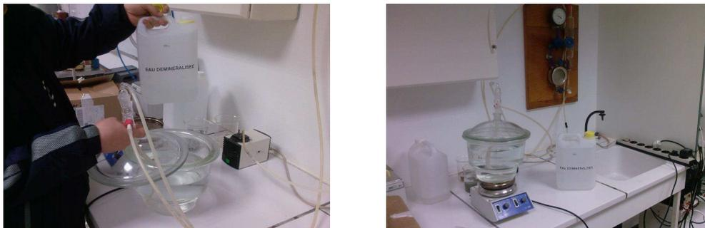
Figure IV.28. Préparation de l'eau désaérée ; matériel utilisé pour la désaération de l'eau
