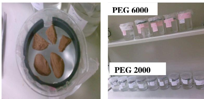
Figure IV.34 : mise en place des échantillons dans les béchers à solutions osmotiques
