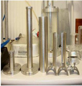
Moule utilisé pour le compactage statique
